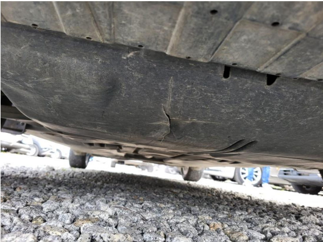
Fot. 35 Osłona dolna silnika - Pęknięcie/rozerwanie 1
