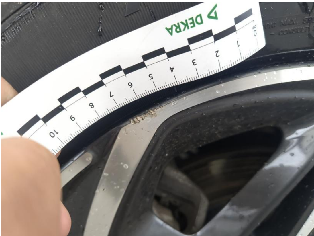
Fot. 45 Felga aluminiowa tylna P - Rysa/odprysk 1
