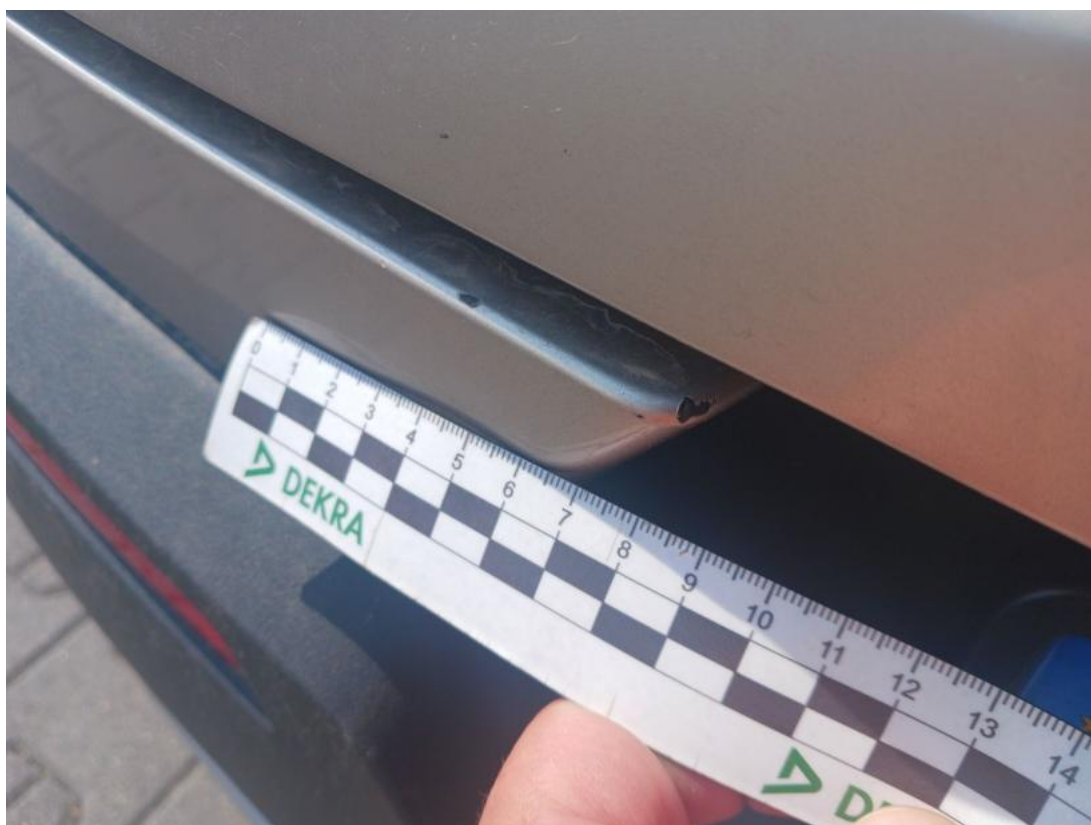
Fot. 40 Zderzak tylny cz śr - Rysa/odprysk 1
