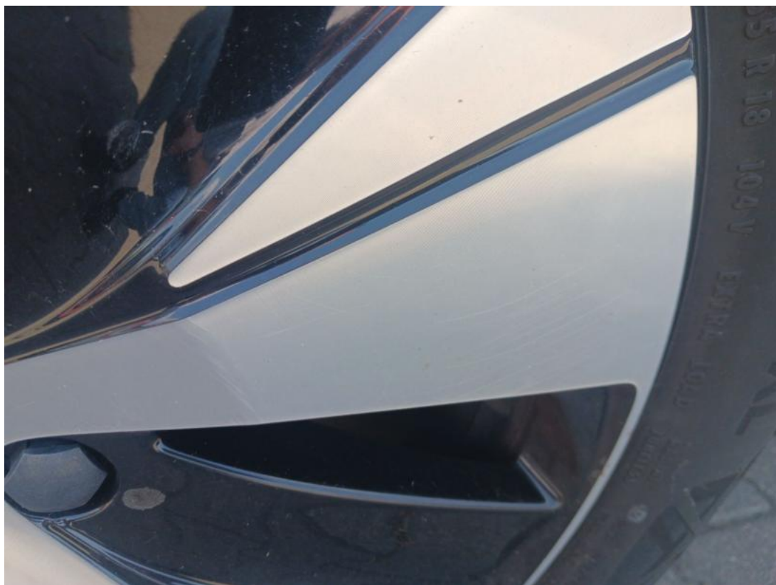
Fot. 39 Felga aluminiowa tylna P - Rysa/odprysk 1
