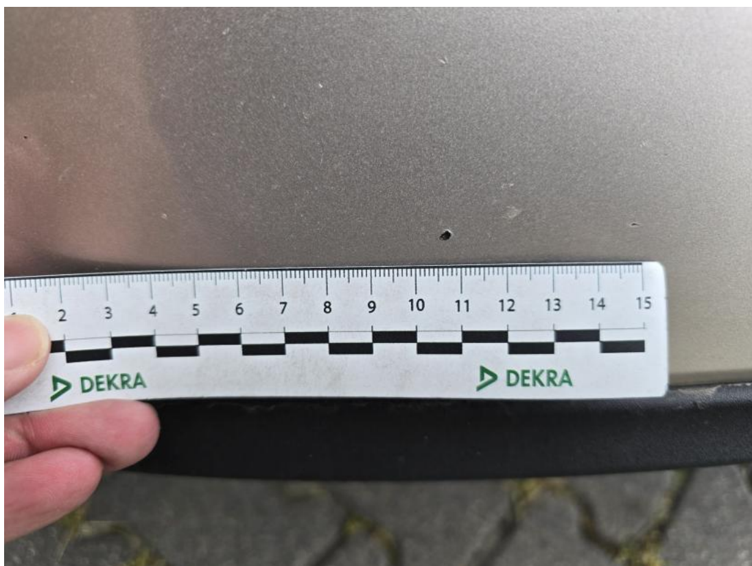
Fot. 40 Zderzak - Rysa/odprysk 1
