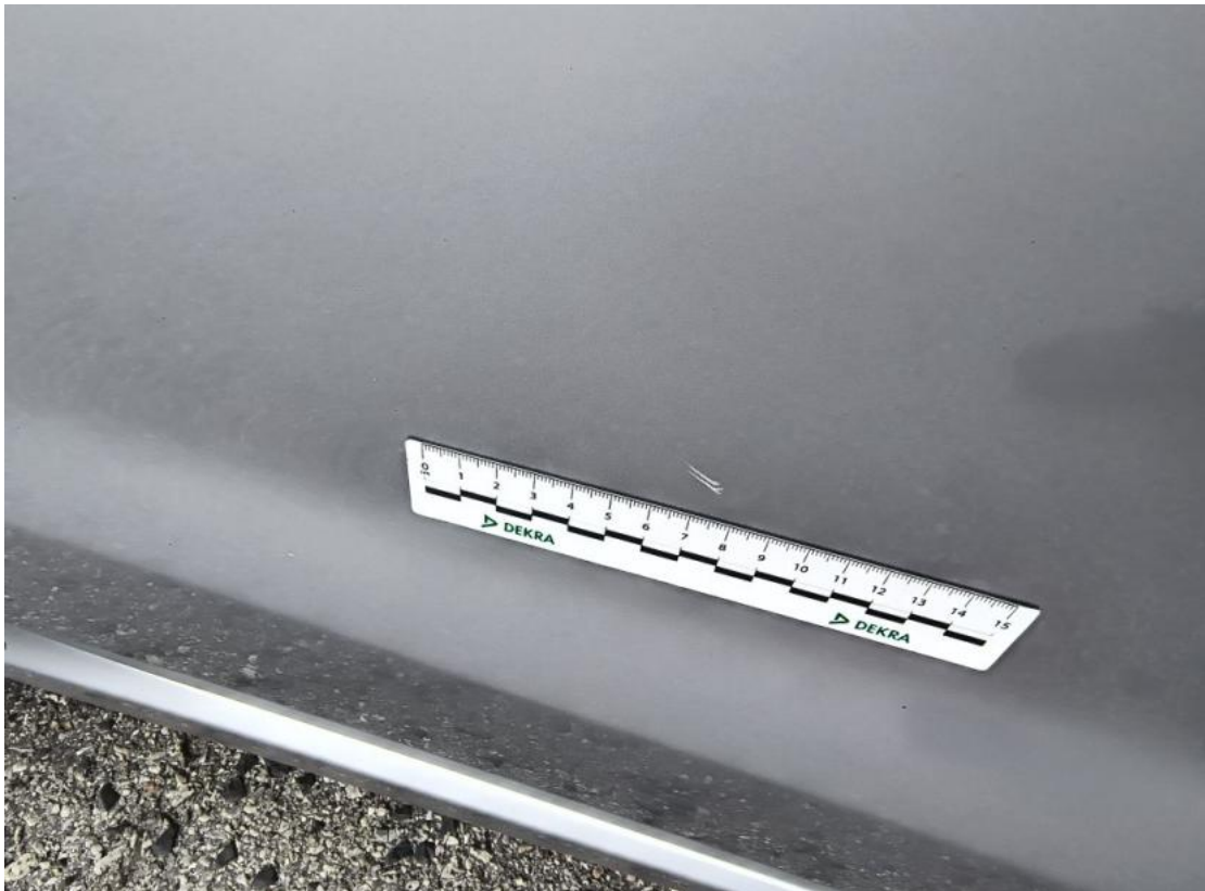
Fot. 43 Drzwi tylne P - Wgniecenie/odkształcenie 1
