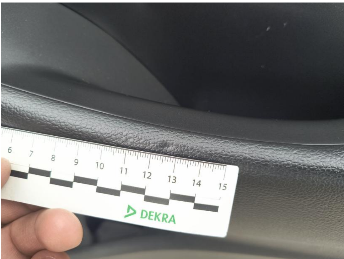
Fot. 62 Tapicerka drzwi tylnych P - Wgniecenie/odkształcenie 1
