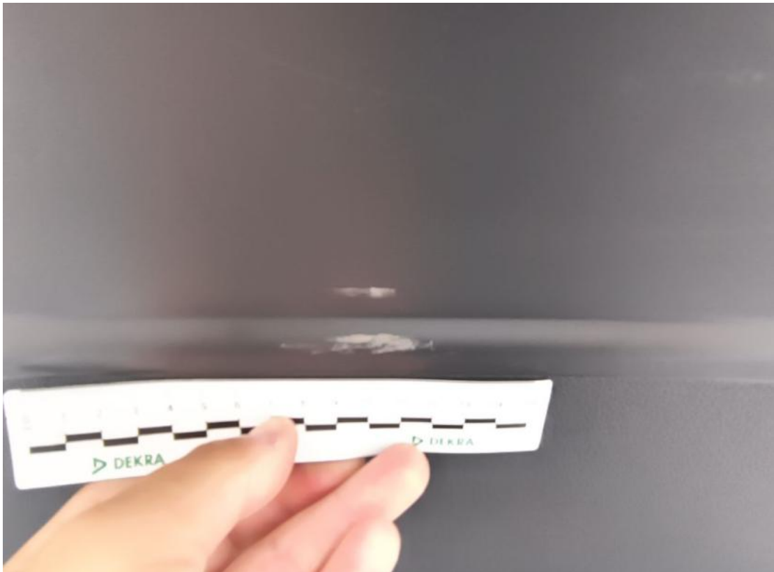
Fot. 67 Wykładzina pokrywy tylnej - Rysa/odprysk 1
