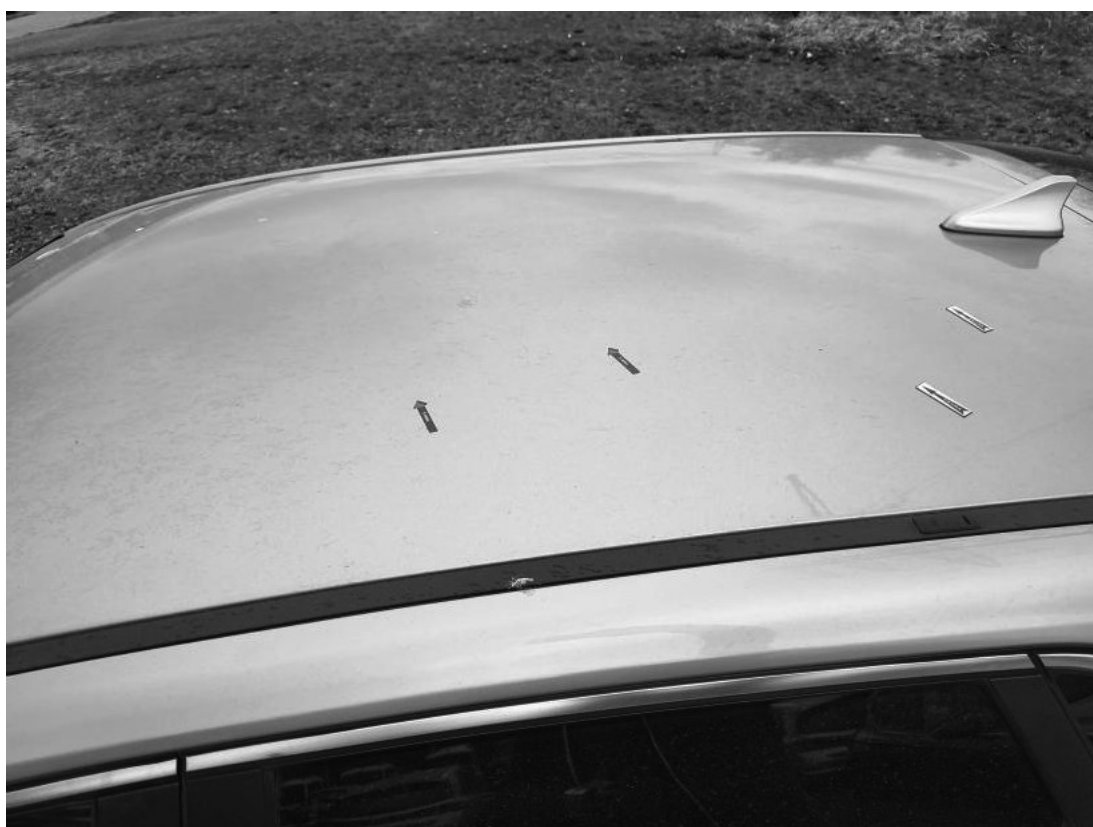
Fot. 54 Dach - Wgniecenie/odkształcenie 1
