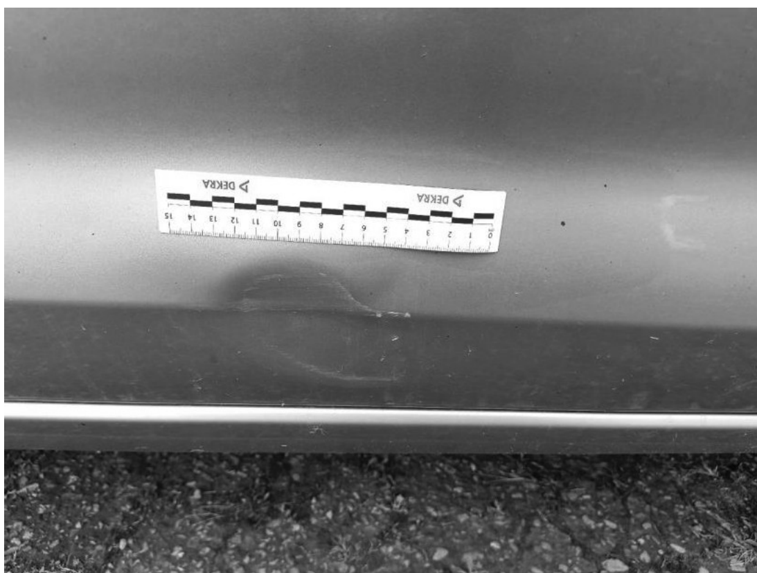
Fot. 44 Drzwi przednie P - Wgniecenie/odkształcenie 2
