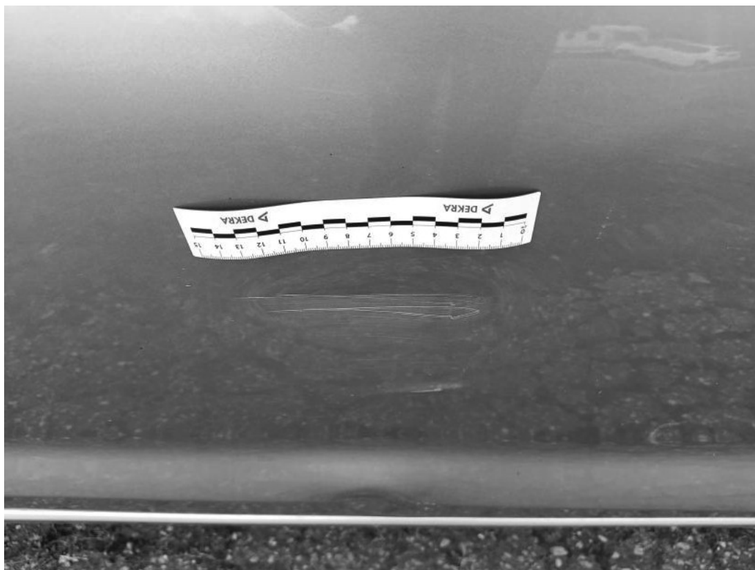
Fot. 43 Drzwi przednie P - Wgniecenie/odkształcenie 1
