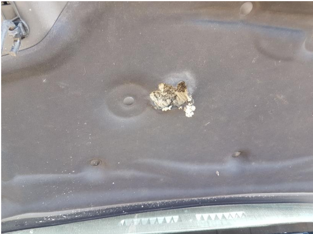
Fot. 35 Wykładzina pokrywy komory silnika - Pęknięcie/rozerwanie 1
