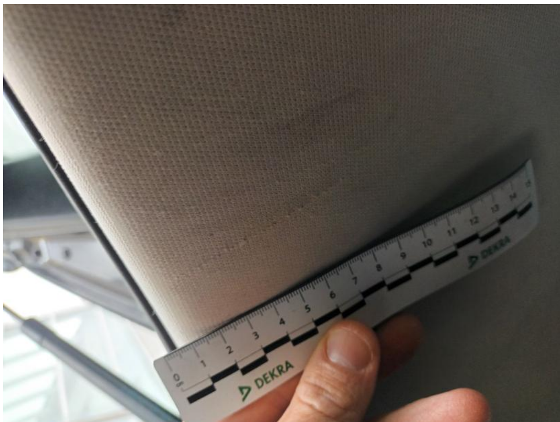
Fot. 53 Podsufitka - Rysa/odprysk 1
