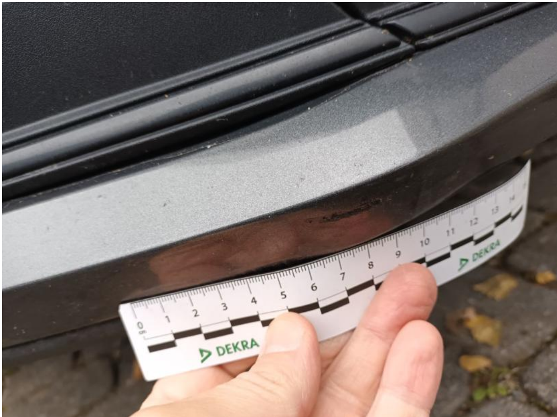
Fot. 39 Zderzak przedni cz dolna - Rysa/odprysk 1
