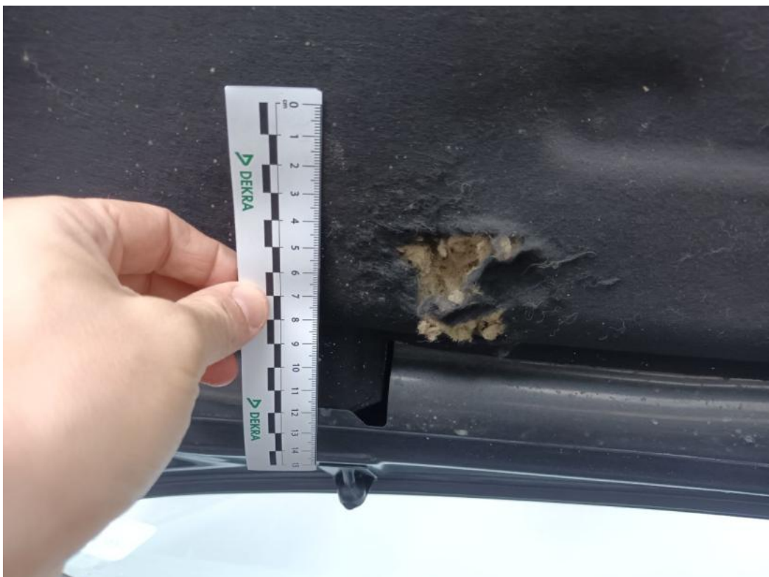
Fot. 38 Wykładzina pokrywy komory silnika - Pęknięcie/rozerwanie 1
