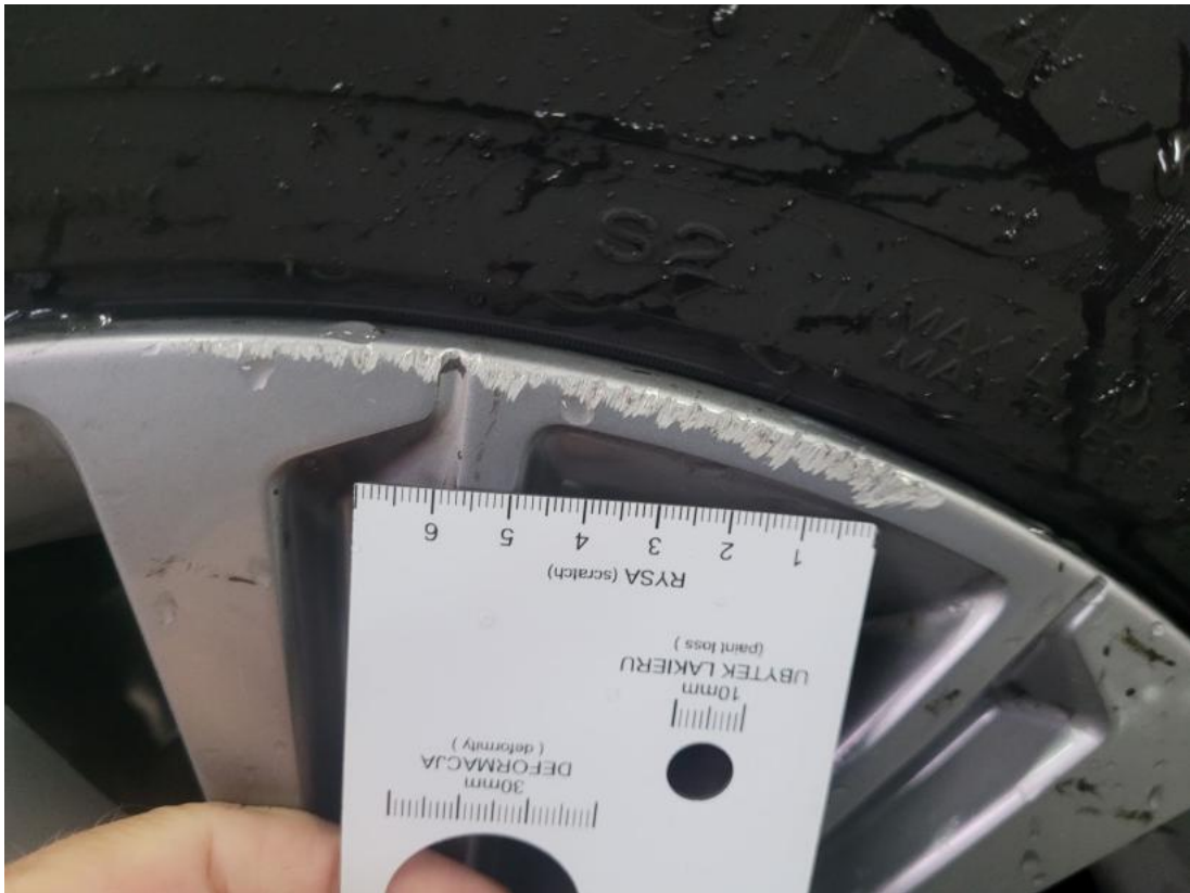
Fot. 43 Felga Aluminiowa przednia L - Rysa/odprysk 1
