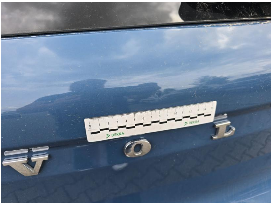
Fot. 46 Pokrywy bagażnika - Wgniecenie/odkształcenie 1
