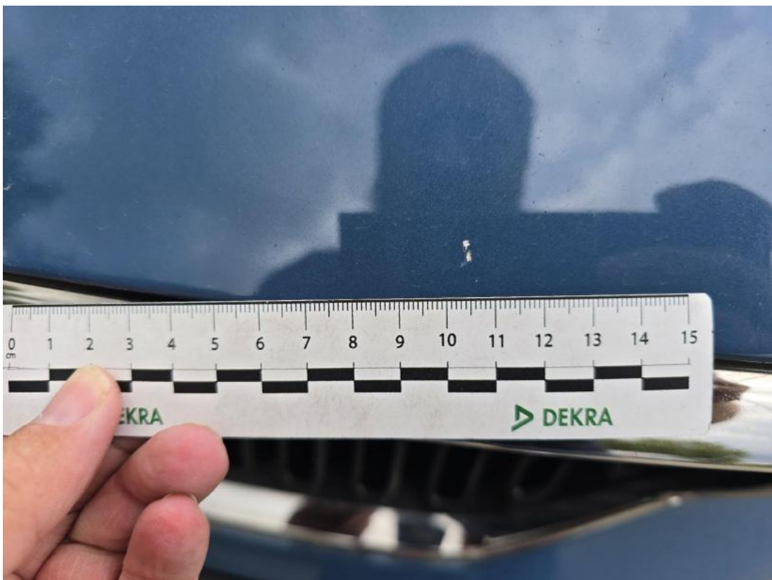
Fot. 38 Pokrywa komory silnika - Rysa/odprysk 1
