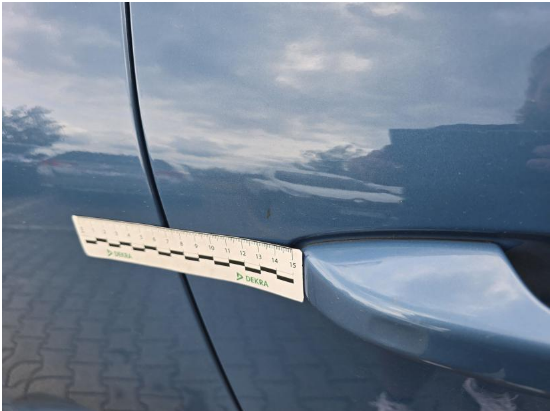
Fot. 45 Drzwi przednie P - Wgniecenie/odkształcenie 1
