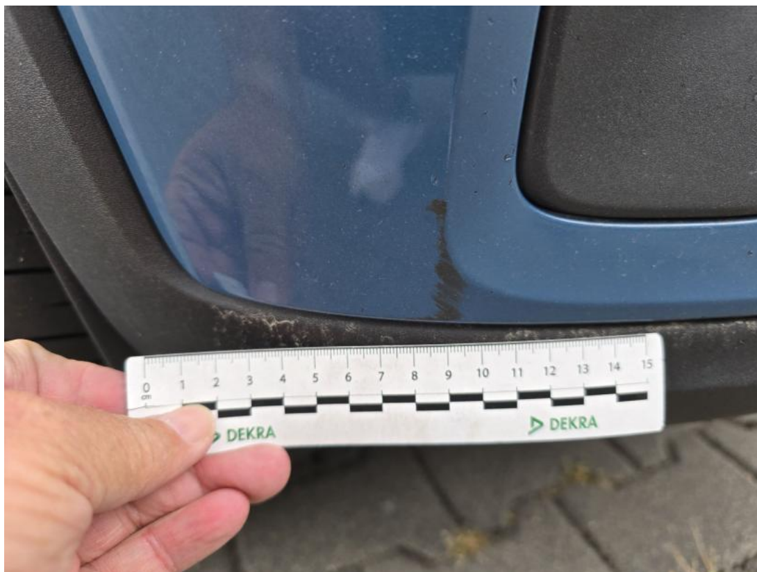
Fot. 43 Zderzak - Rysa/odprysk 1
