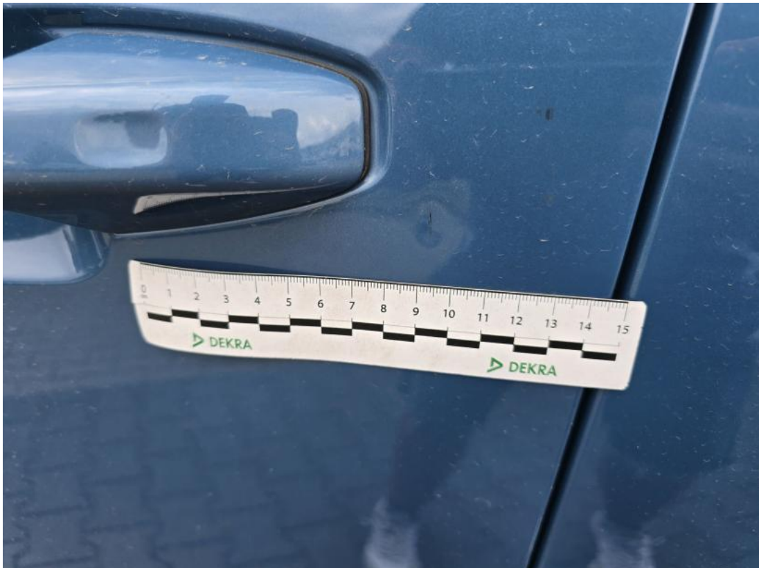
Fot. 47 Drzwi przed L - Wgniecenie/odkształcenie 1
