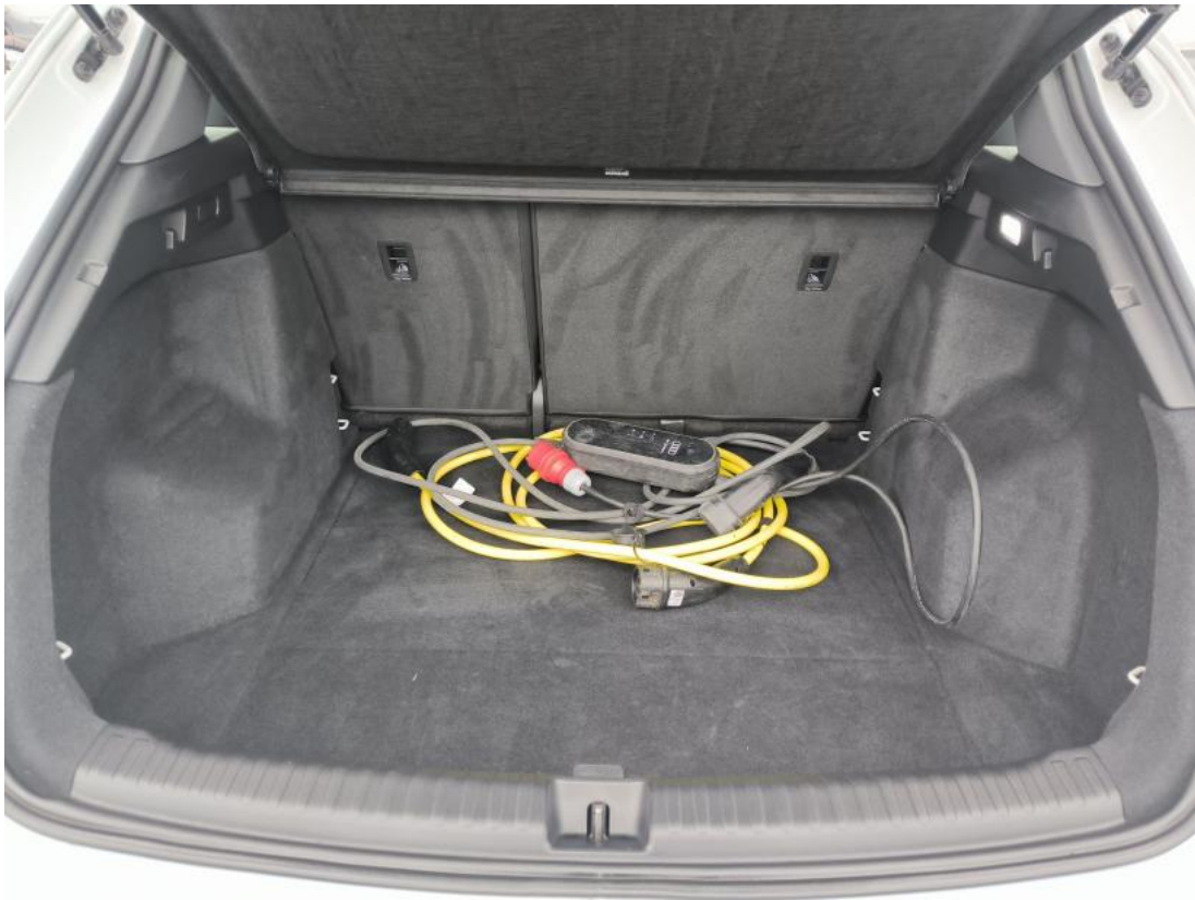
Fot. 29 Przewód ładowania baterii trakcyjnej
