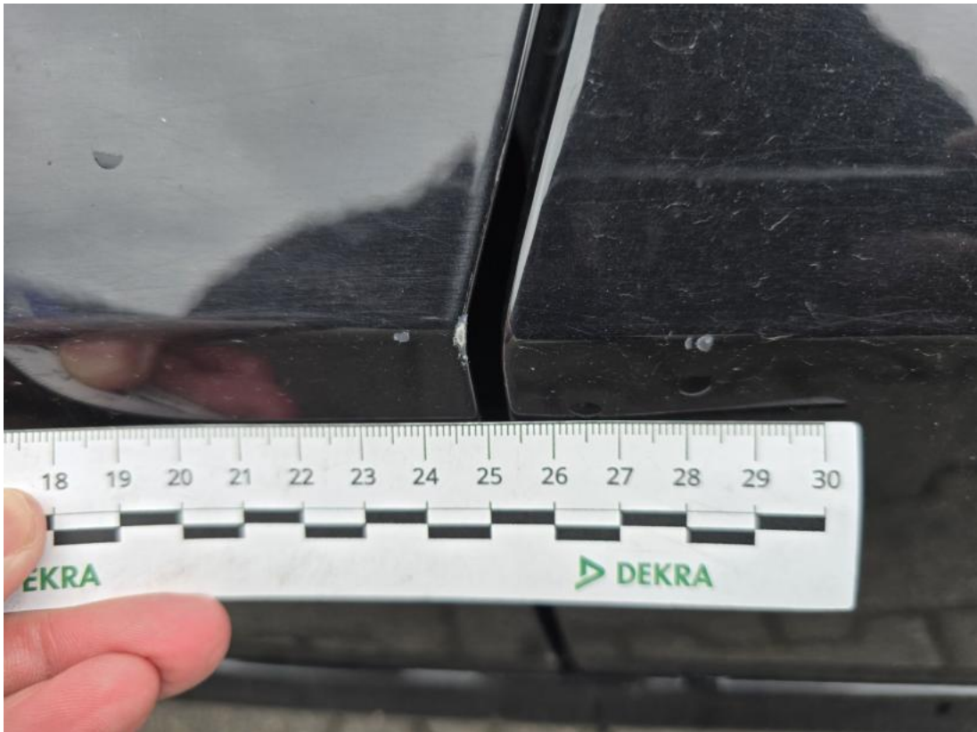
Fot. 51 Drzwi przed L - Rysa/odprysk 1
