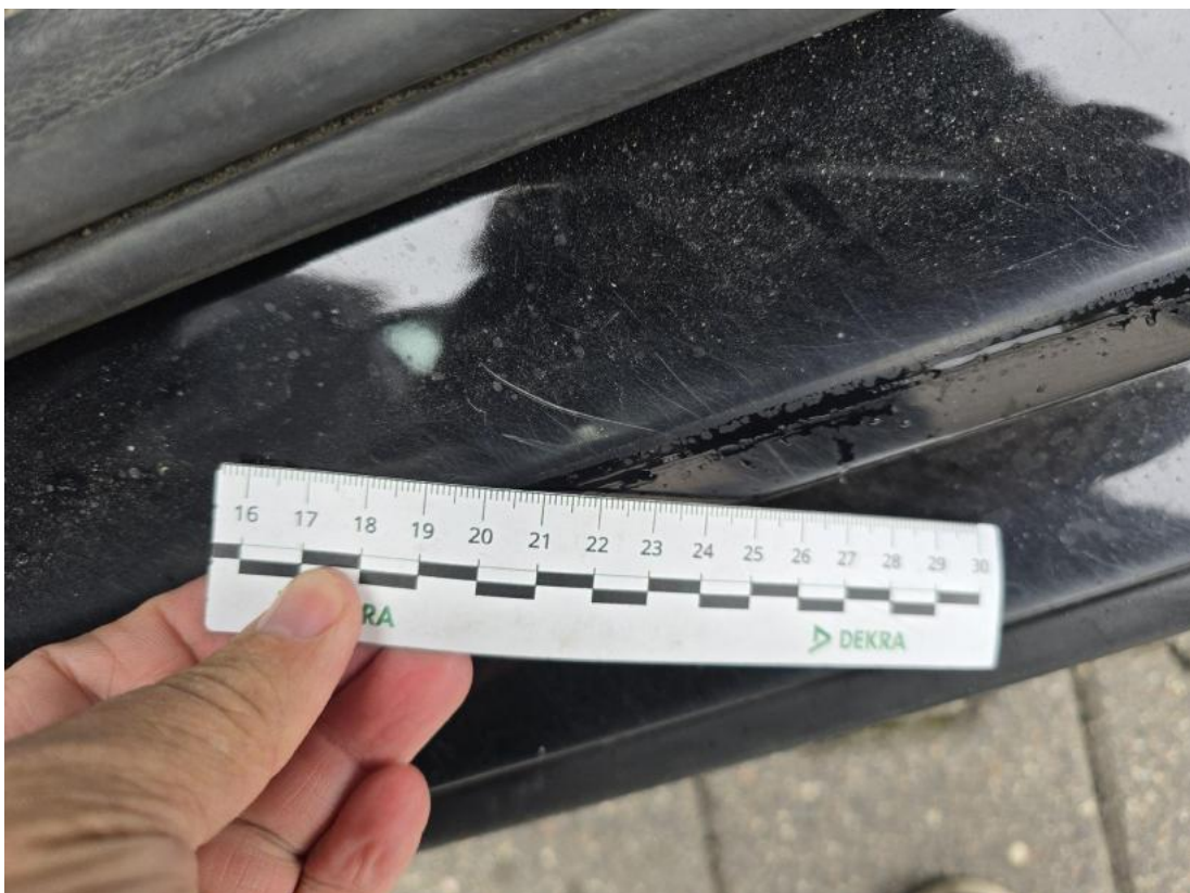
Fot. 54 Próg L - Rysa/odprysk 1
