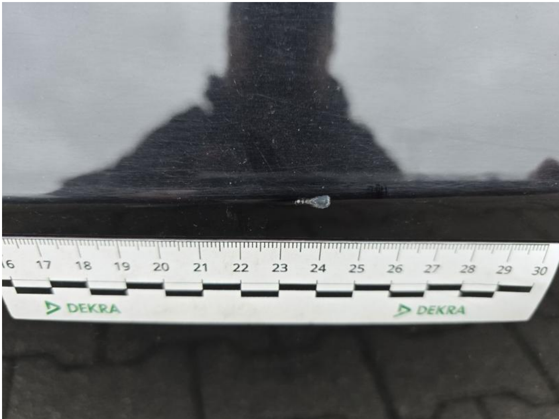
Fot. 53 Drzwi tylne L - Rysa/odprysk 1
