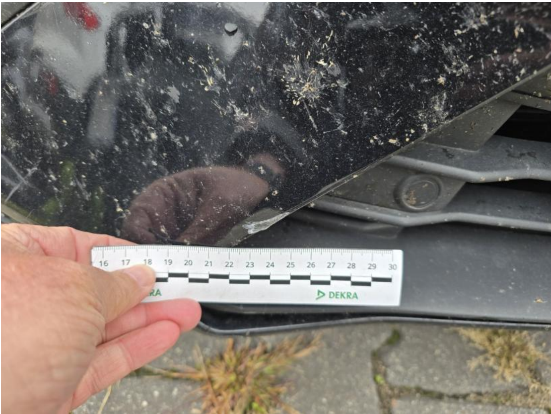
Fot. 41 Zderzak - Rysa/odprysk 1
