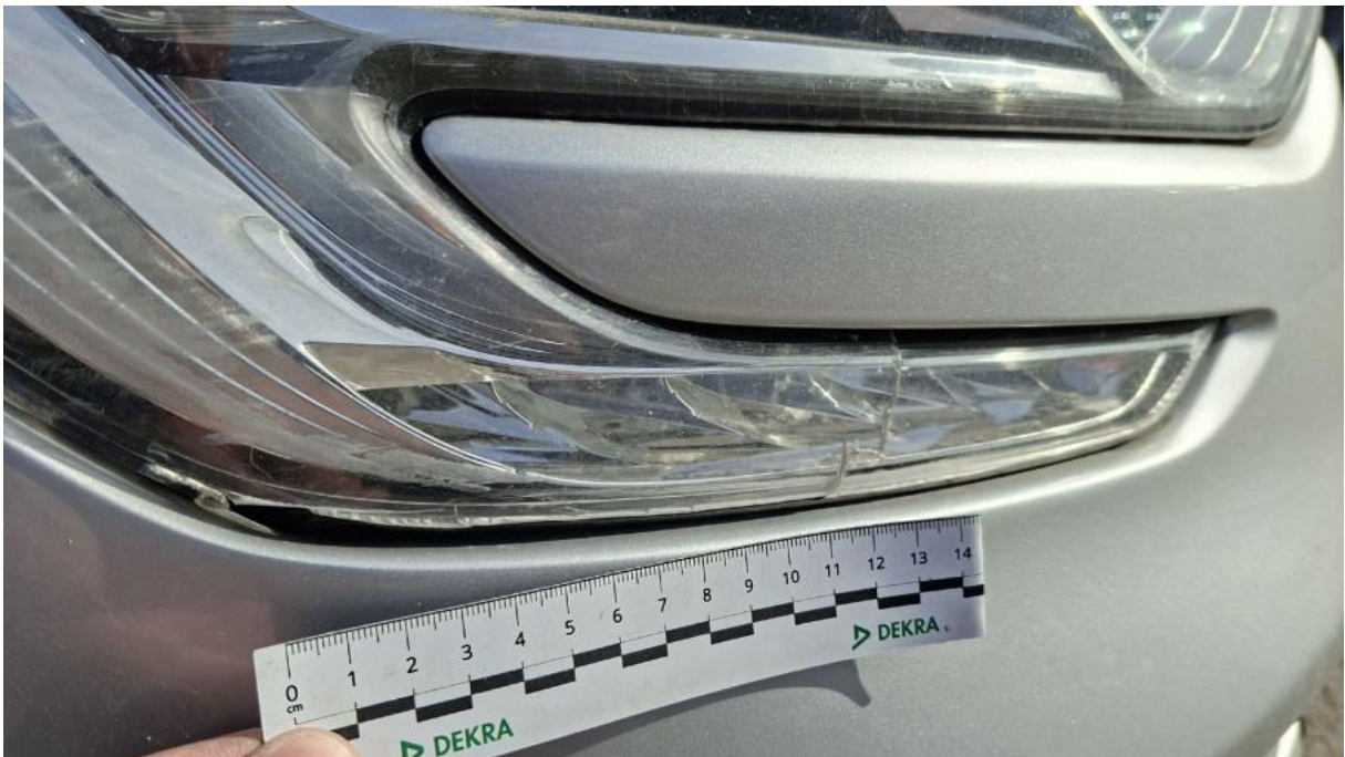
Fot. 46 Reflektor P - Pęknięcie/rozerwanie 1
