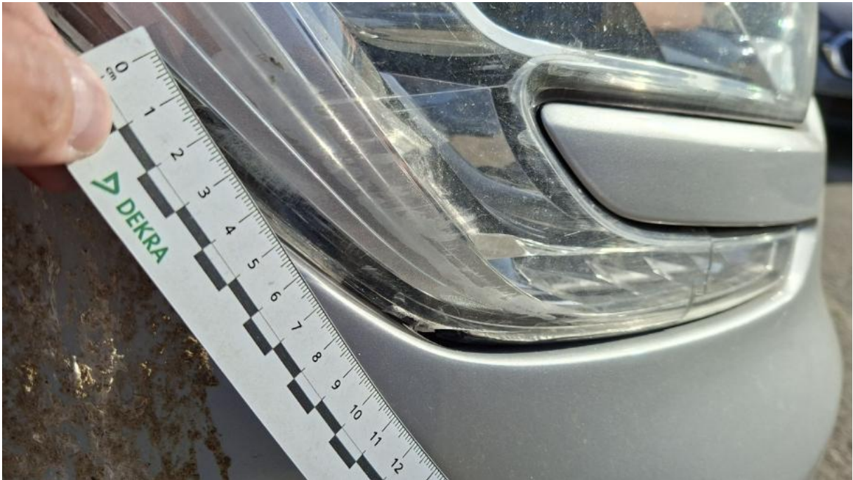
Fot. 45 Reflektor P - Rysa/odprysk 1
