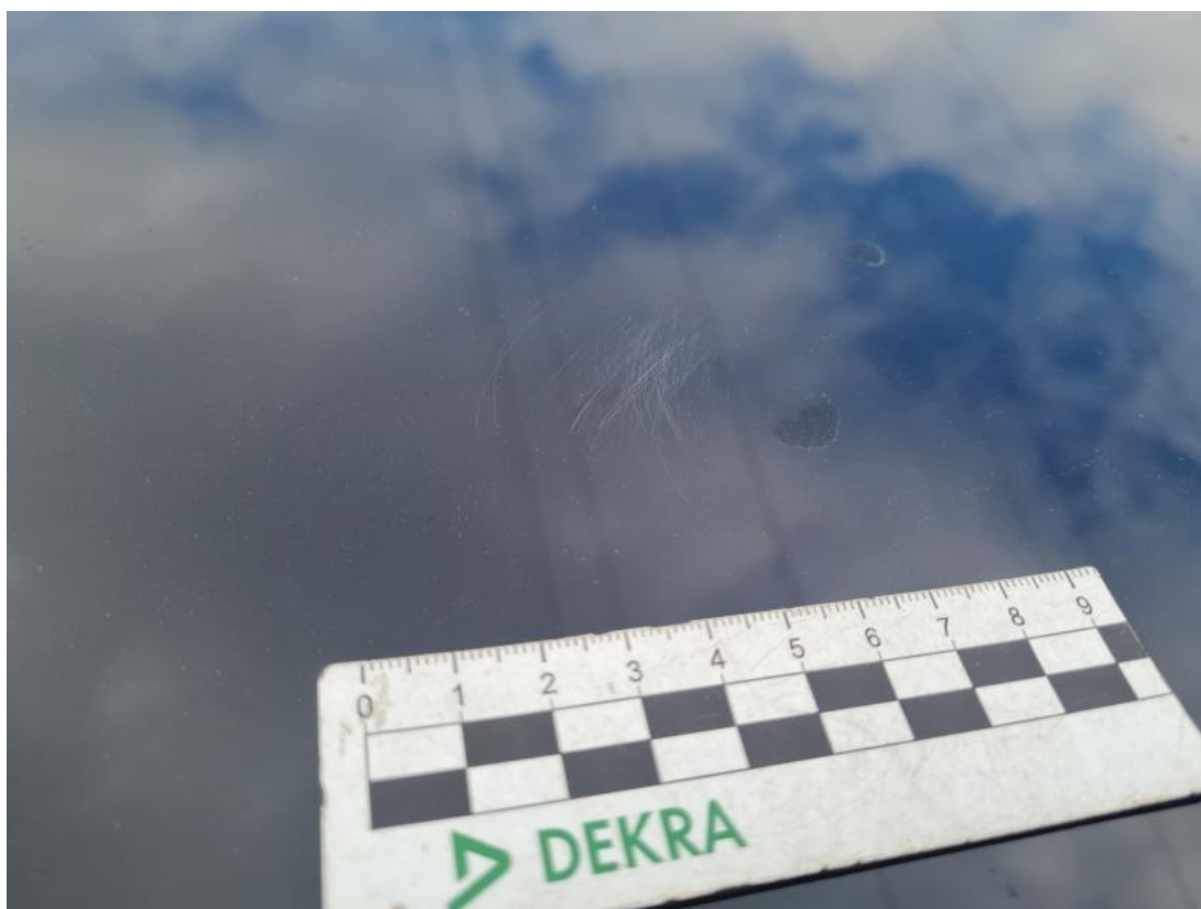
Fot. 47 Pokrywa komory silnika() - Rysa/odprysk 3
