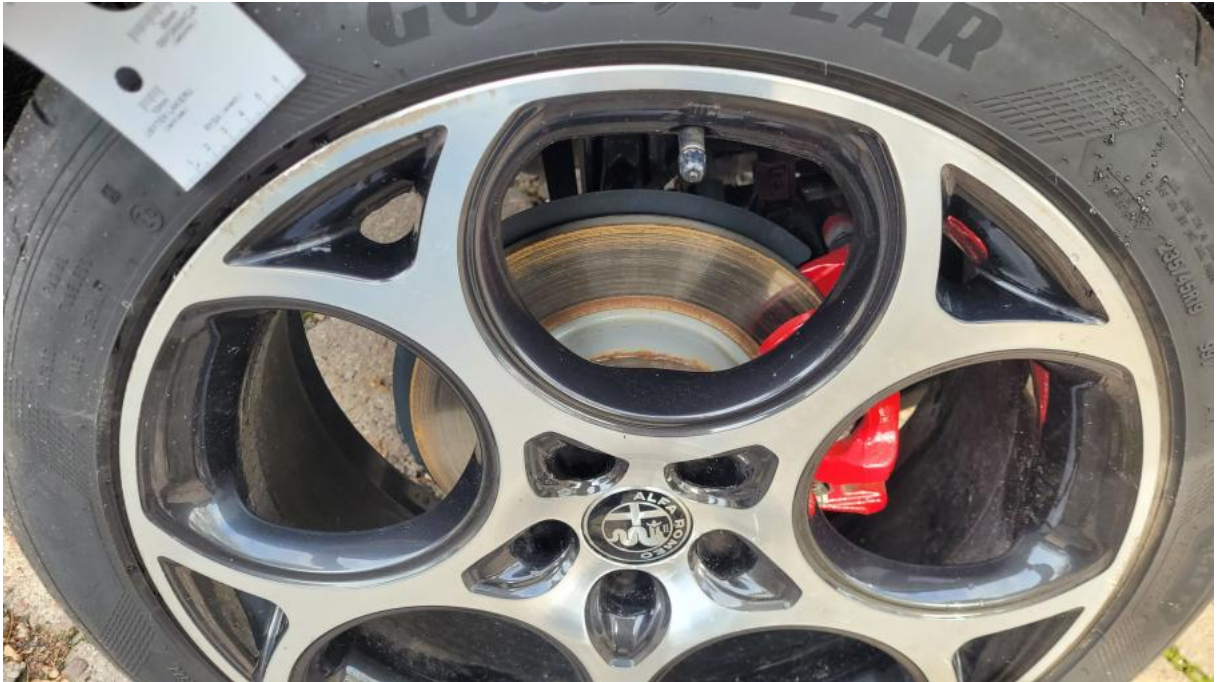
Fot. 37 Felga aluminiowa tylna P - Rysa/odprysk 1
