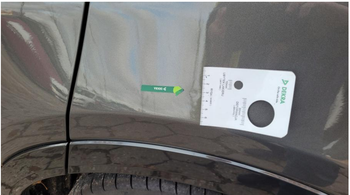
Fot. 38 Błotnik tylny L / Ściana boczna L - Wgniecenie/odkształcenie 1
