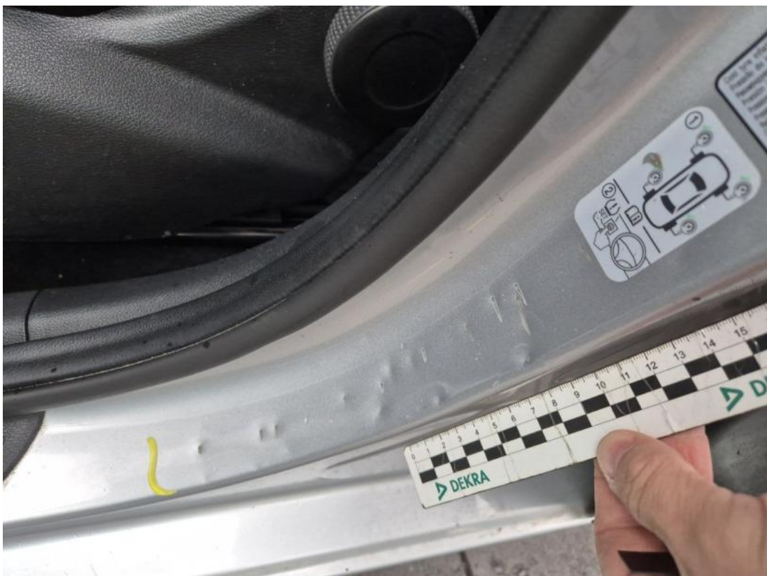
Fot. 38 Słupek środkowy L - Rysa/odprysk 1
