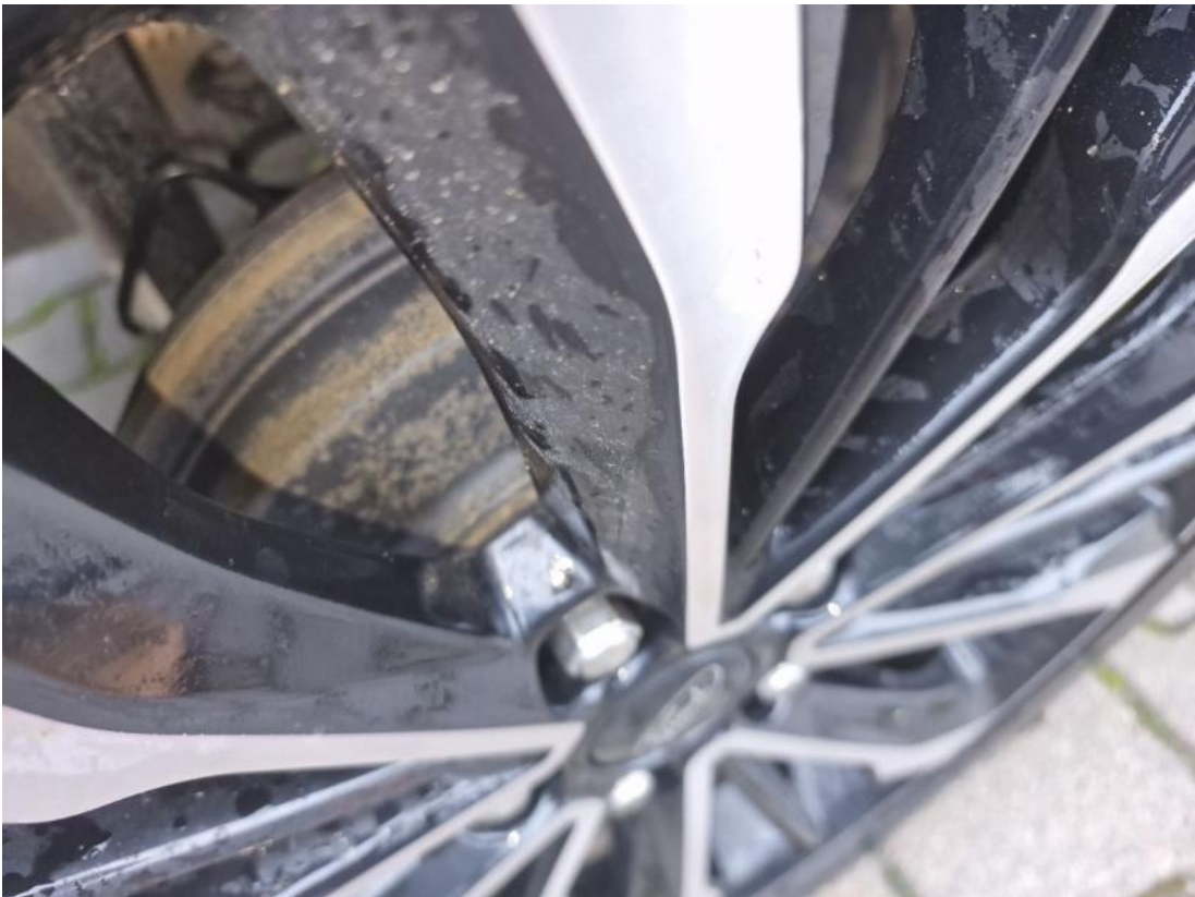
Fot. 29 Tarcza hamulcowa tylna prawa
