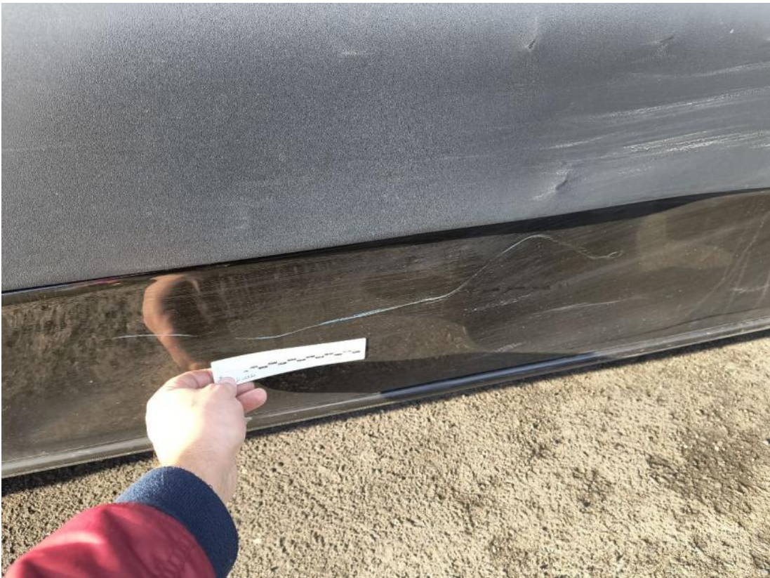
Fot. 59 Drzwi tylne P() - Rysa/odprysk 3
