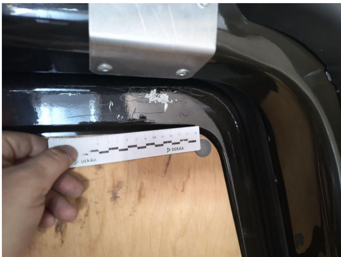
Fot. 117 Drzwi tyłu lewe - Rysa/odprysk 1
