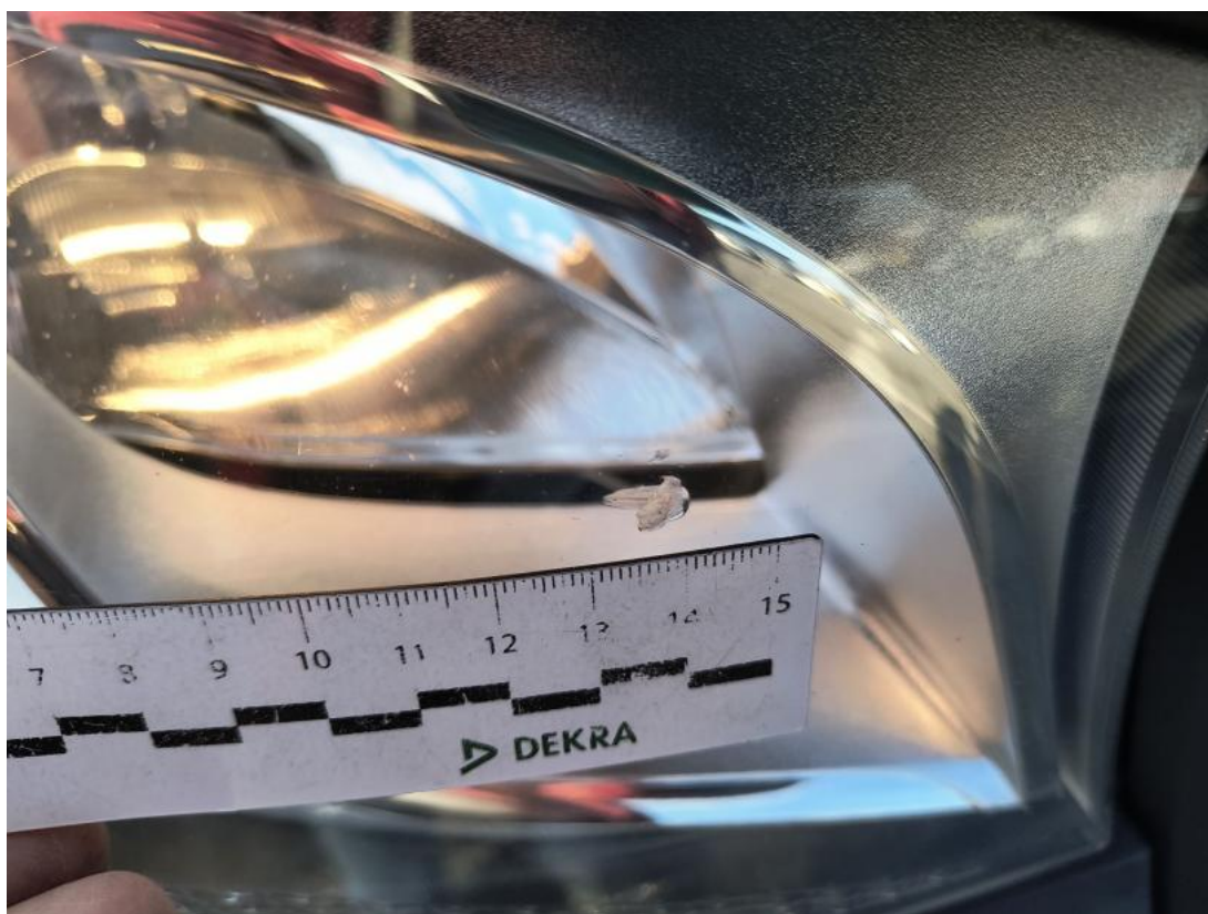
Fot. 51 Reflektor P - Rysa/odprysk 1
