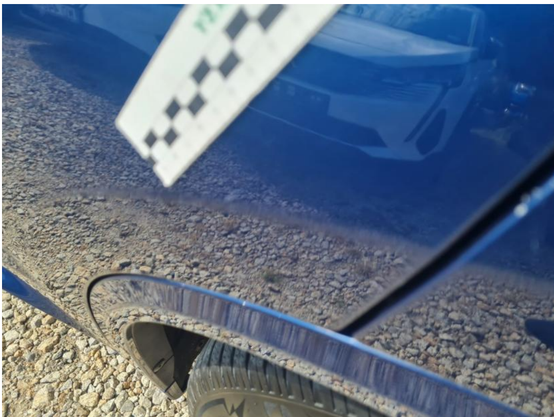
Fot. 62 Drzwi tylne L - Rysa/odprysk 1
