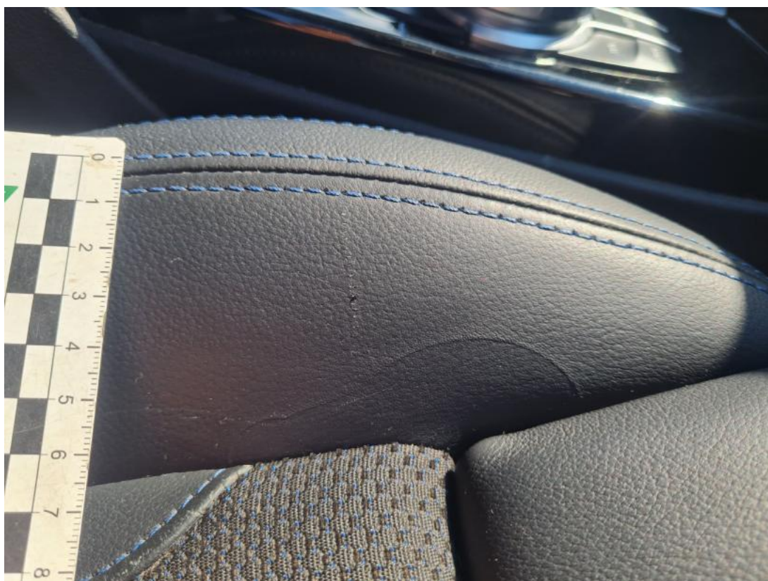
Fot. 64 Fotel prz. praw. - Rysa/odprysk 1
