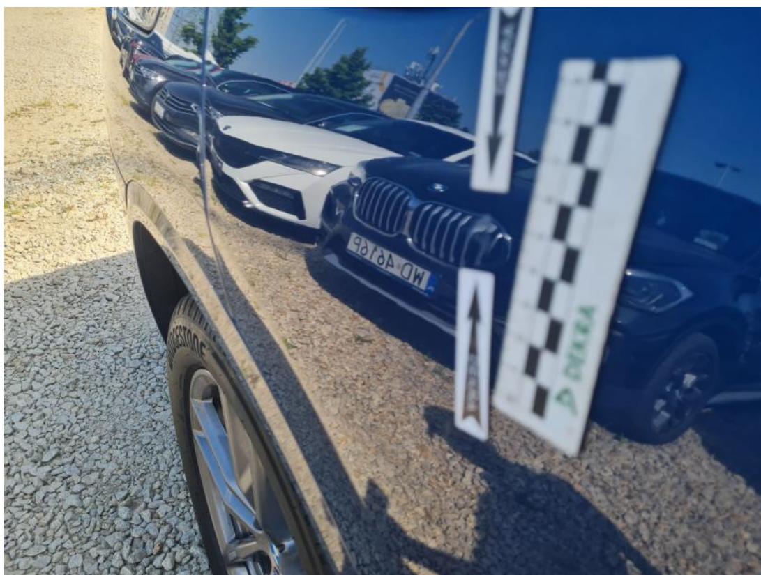
Fot. 48 Drzwi tylne P - Wgniecenie/odkształcenie 1
