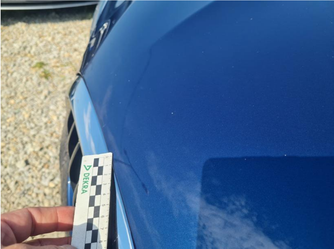
Fot. 45 Pokrywa komory silnika() - Rysa/odprysk 3
