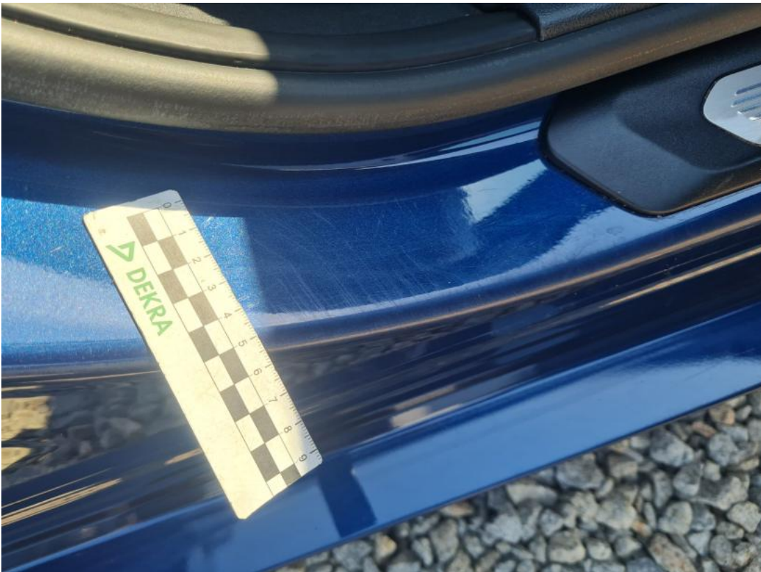
Fot. 49 Próg P - Rysa/odprysk 1
