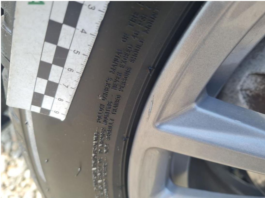
Fot. 61 Felga aluminiowa tylna L - Rysa/odprysk 1
