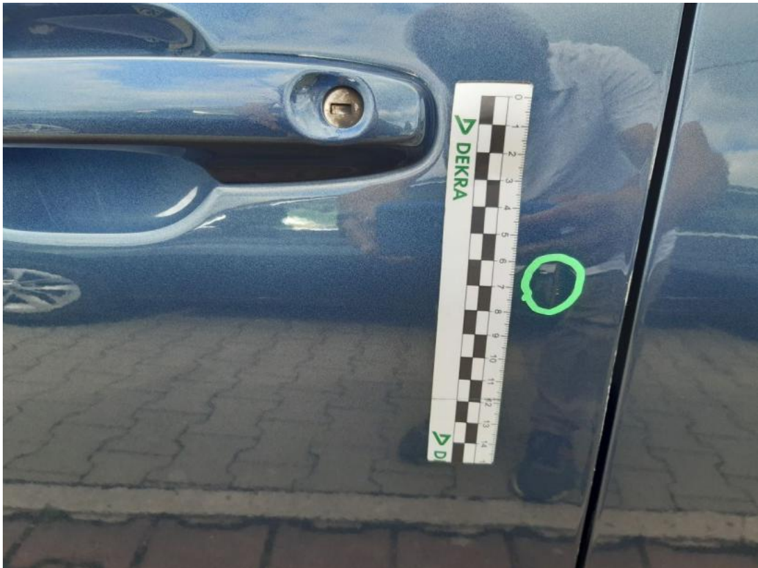
Fot. 41 Drzwi przed L - Wgniecenie/odkształcenie 1
