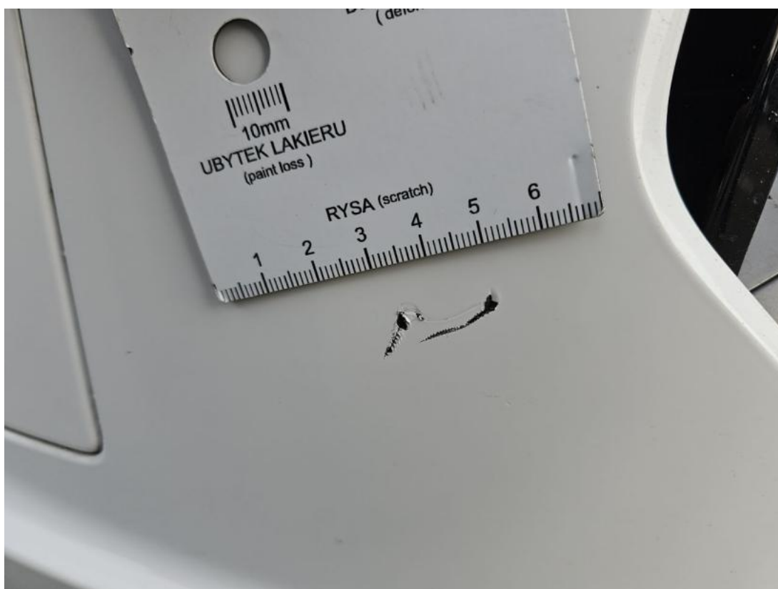
Fot. 38 Zderzak - Rysa/odprysk 2
