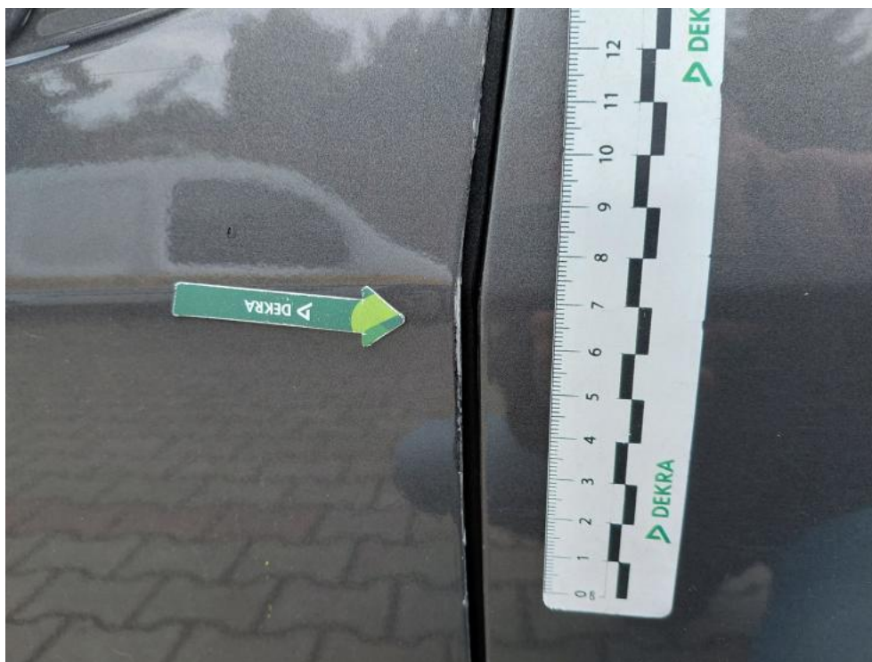
Fot. 61. Drzwi P L - odpryski lakieru 1
