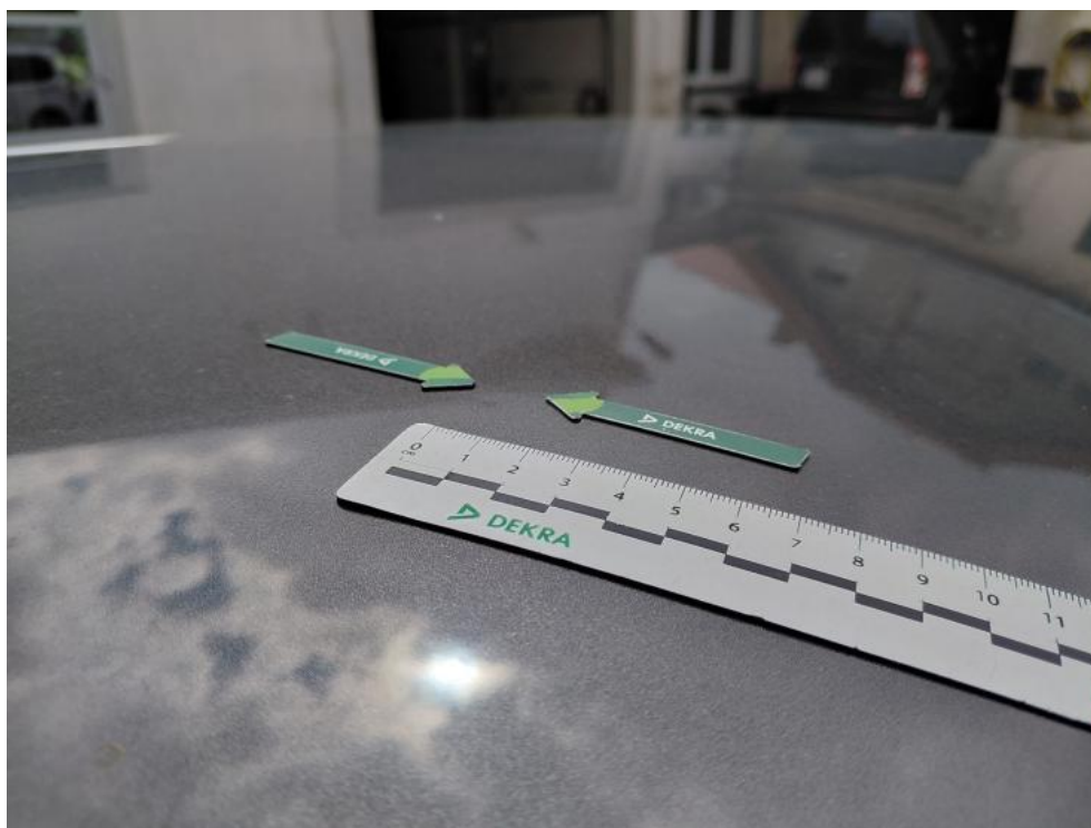
Fot. 49. Dach stały - wgniecenia w ilości pow. 3 1
