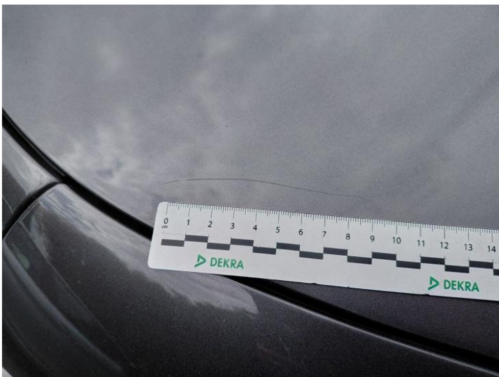
Fot. 54. Pokrywa - zarysowanie 1
