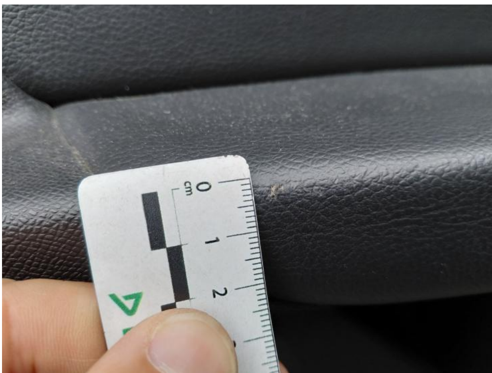
Fot. 90. Tapicerka drzwi TL standard. - zarysowanie 1
