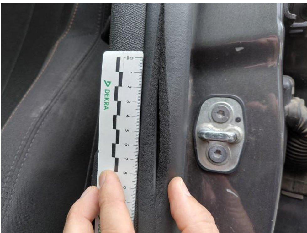
Fot. 68. Uszczelka otworu drzwi P L - rozerwanie 1
