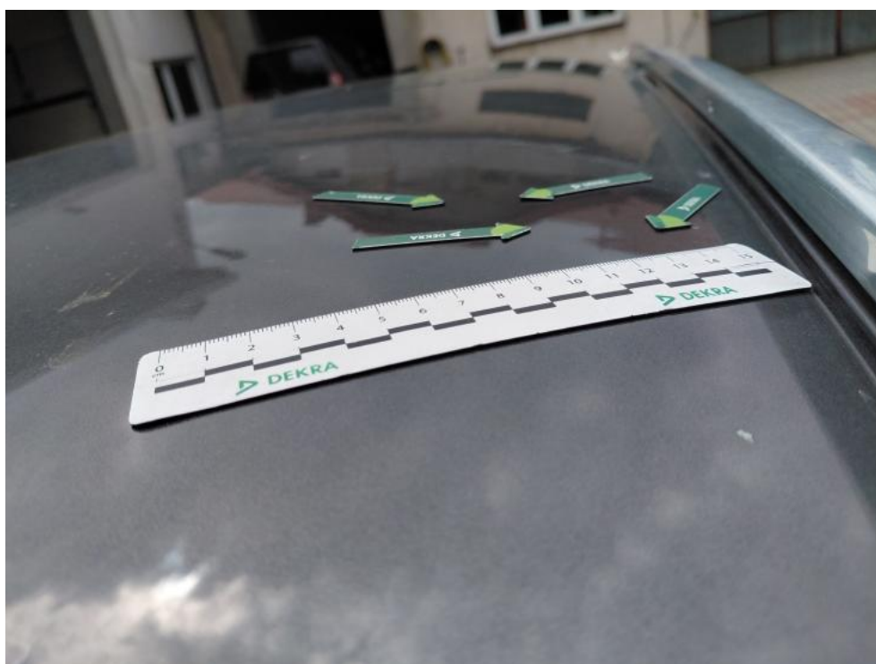
Fot. 50. Dach stały - wgniecenia w ilości pow. 3 2
