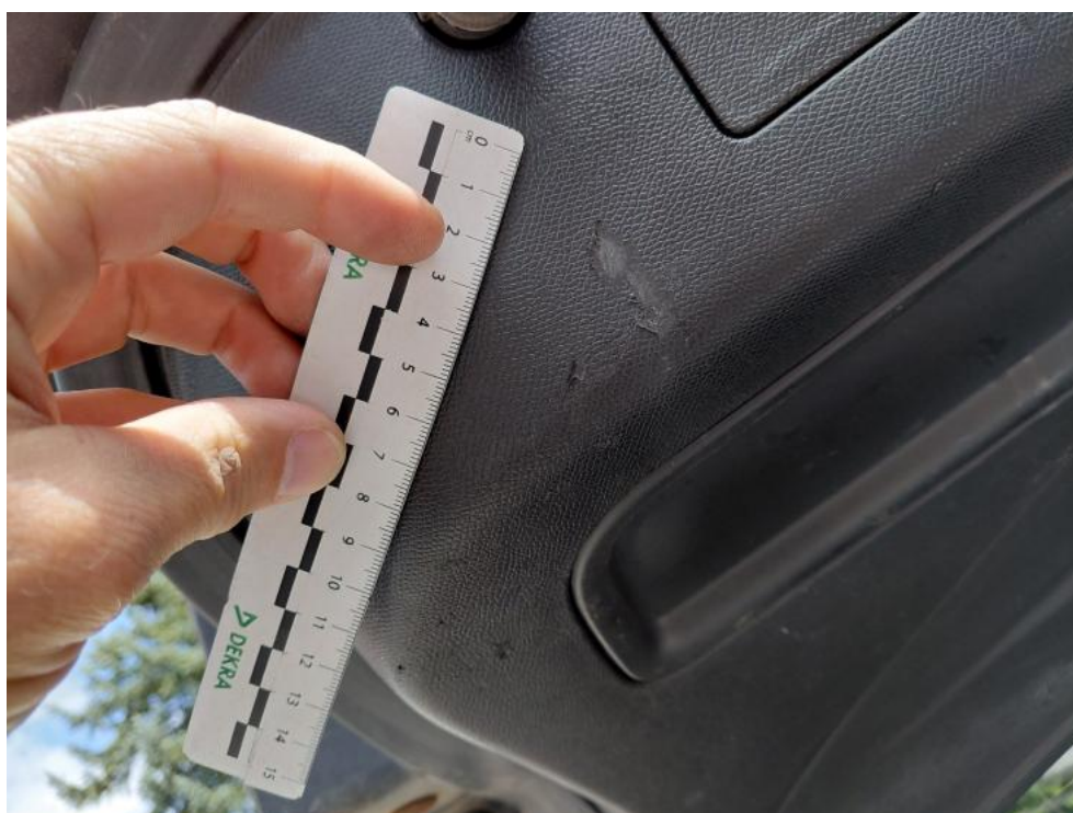
Fot. 98. Wykładzina pokrywy T - zarysowanie głębokie 1
