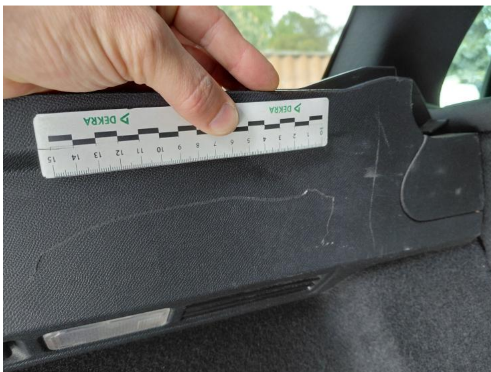
Fot. 104. Wykładzina przestrzeni bagażowej - zarysowanie głębokie 2
