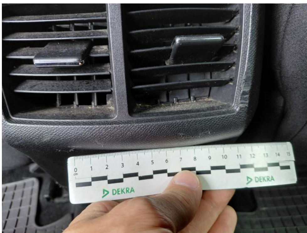
Fot. 78. Konsola tunelu śr. tworzywo - zarysowanie 1
