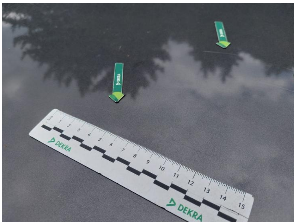
Fot. 48. Dach stały - zarysowanie 2
