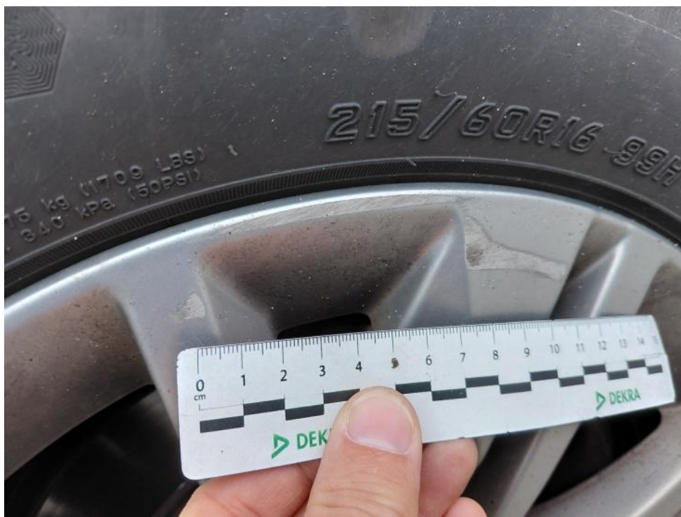
Fot. 45. Felga alum. chrom. TL - zarysowanie głębokie 2
