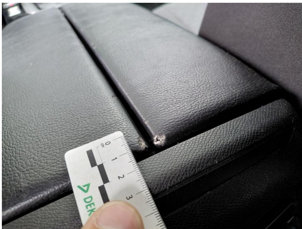
Fot. 81. Podłokietnik P skóra - pęknięcie 1
