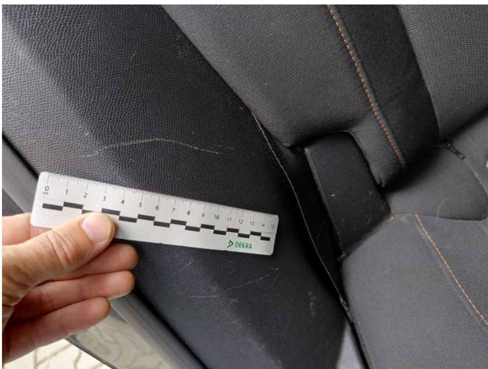
Fot. 84. Wykładzina słupka (C) dolna TP - zarysowanie 1
