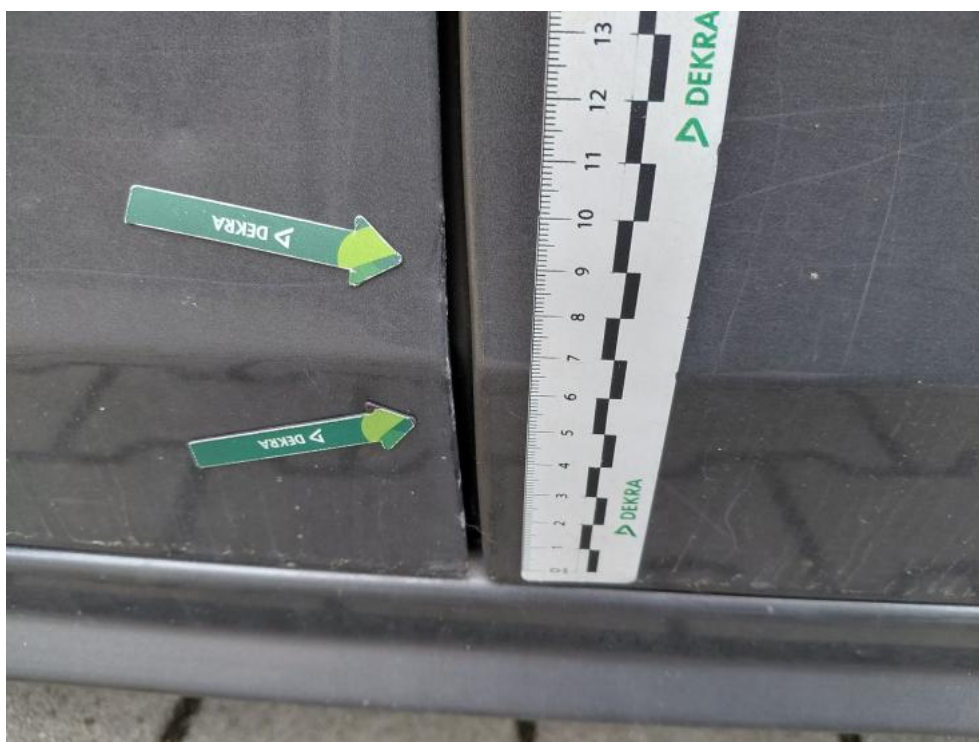
Fot. 62. Drzwi P L - odpryski lakieru 2
