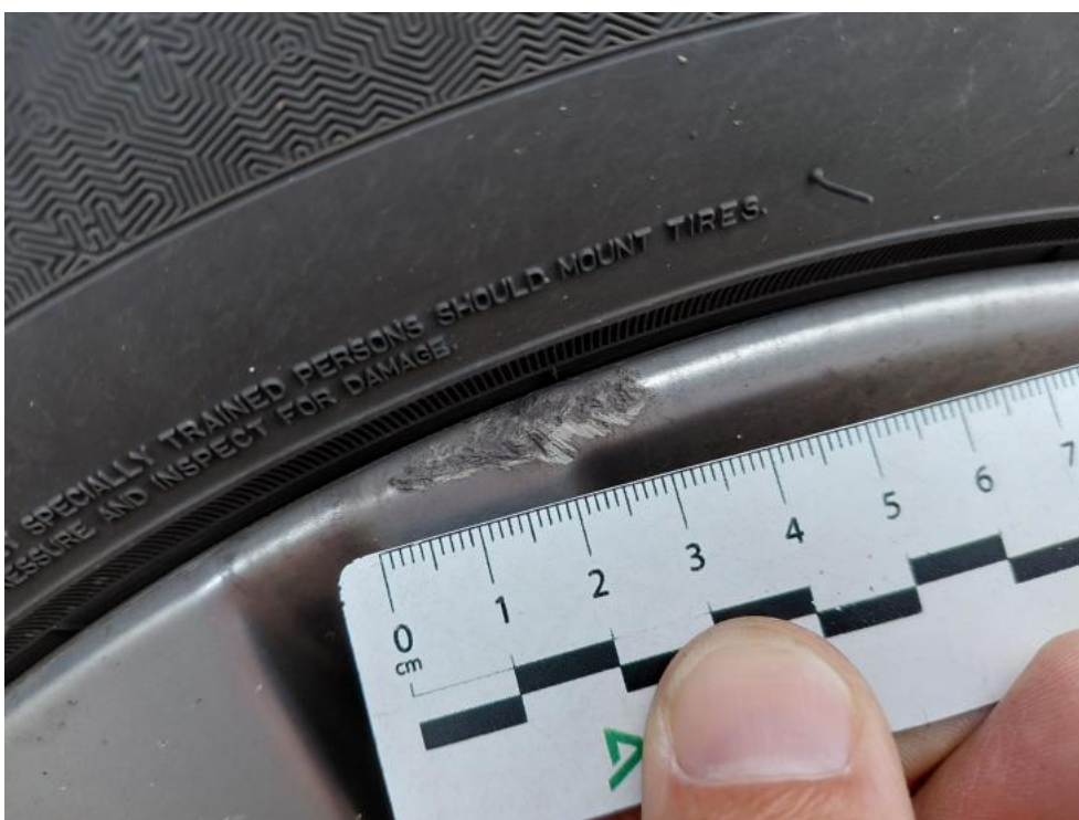
Fot. 44. Felga alum. chrom. TL - zarysowanie głębokie 1
