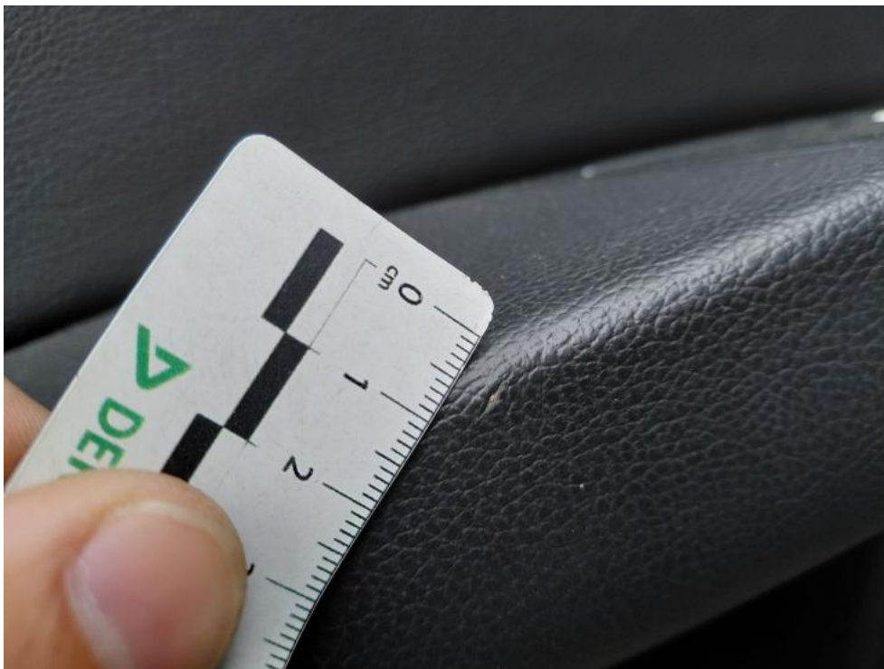
Fot. 91. Tapicerka drzwi TL standard. - zarysowanie 2
