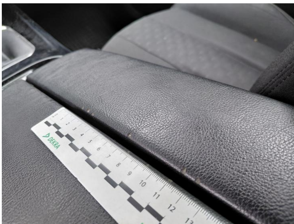
Fot. 82. Podłokietnik P skóra - pęknięcie 2
