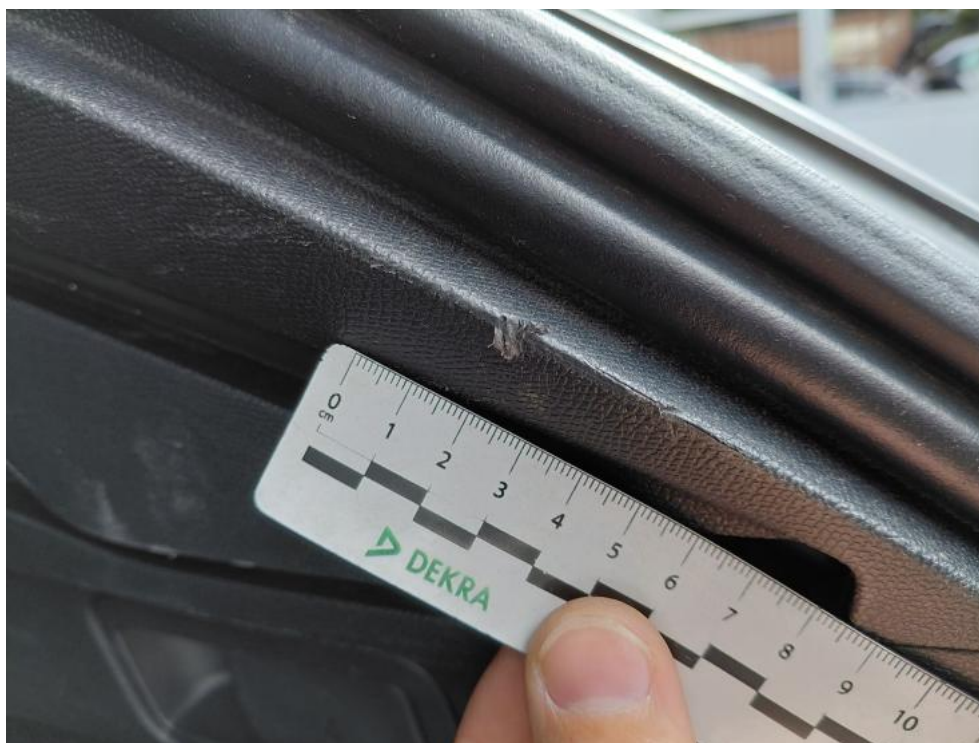
Fot. 103. Wykładzina przestrzeni bagażowej - zarysowanie głębokie 1
