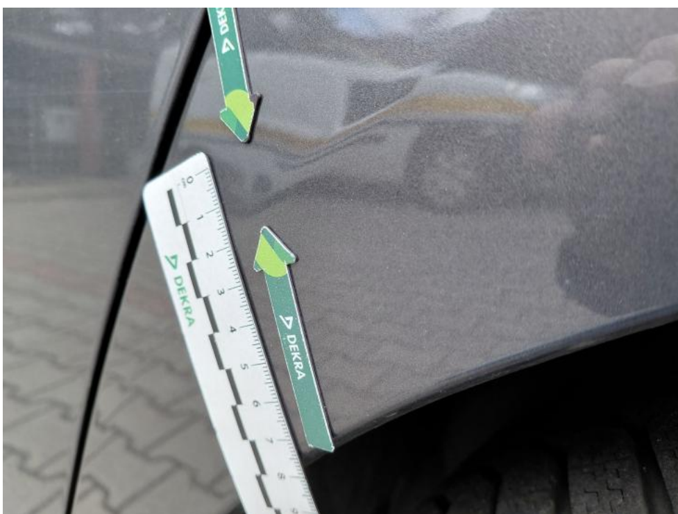
Fot. 42. Błotnik metal TL - wgniecenie o śr. do 20 mm 1
