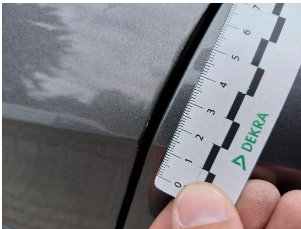
Fot. 63. Drzwi P L() - odpryski lakieru 3
