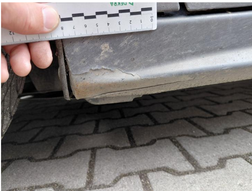
Fot. 66. Próg L - łuszczenie lakieru 1
