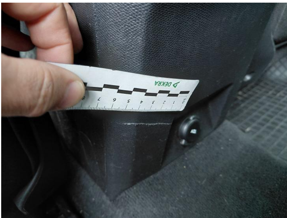
Fot. 79. Konsola tunelu śr. tworzywo - zarysowanie 2
