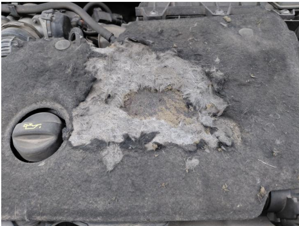
Fot. 53. Osłona silnika PRZ - rozerwanie 1
