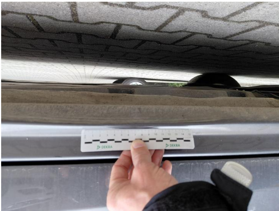
Fot. 65. Próg L - deformacja 1
