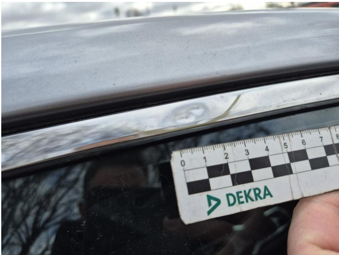
Fot. 36 Listwa drzwi przednich P - Wgniecenie/odkształcenie 1
