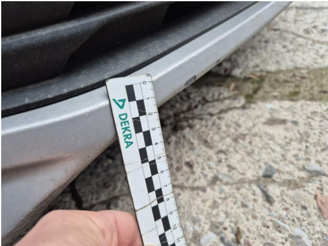
Fot. 35 Zderzak - Rysa/odprysk 1
