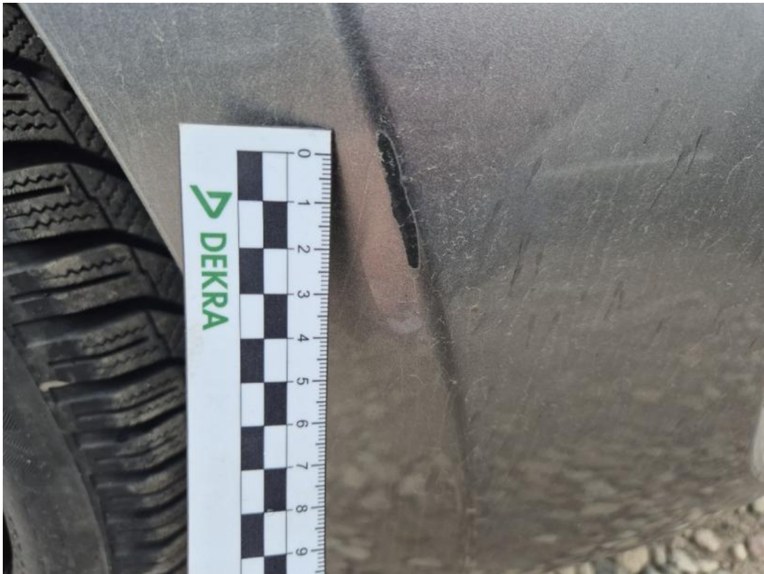
Fot. 39 Zderzak - Rysa/odprysk 1
