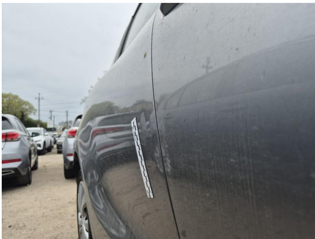
Fot. 42 Drzwi tylne P - Wgniecenie/odkształcenie 1
