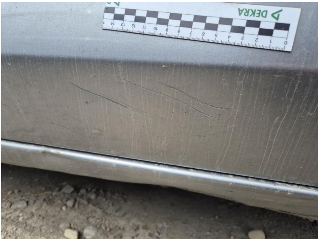
Fot. 40 Drzwi przednie P - Rysa/odprysk 1
