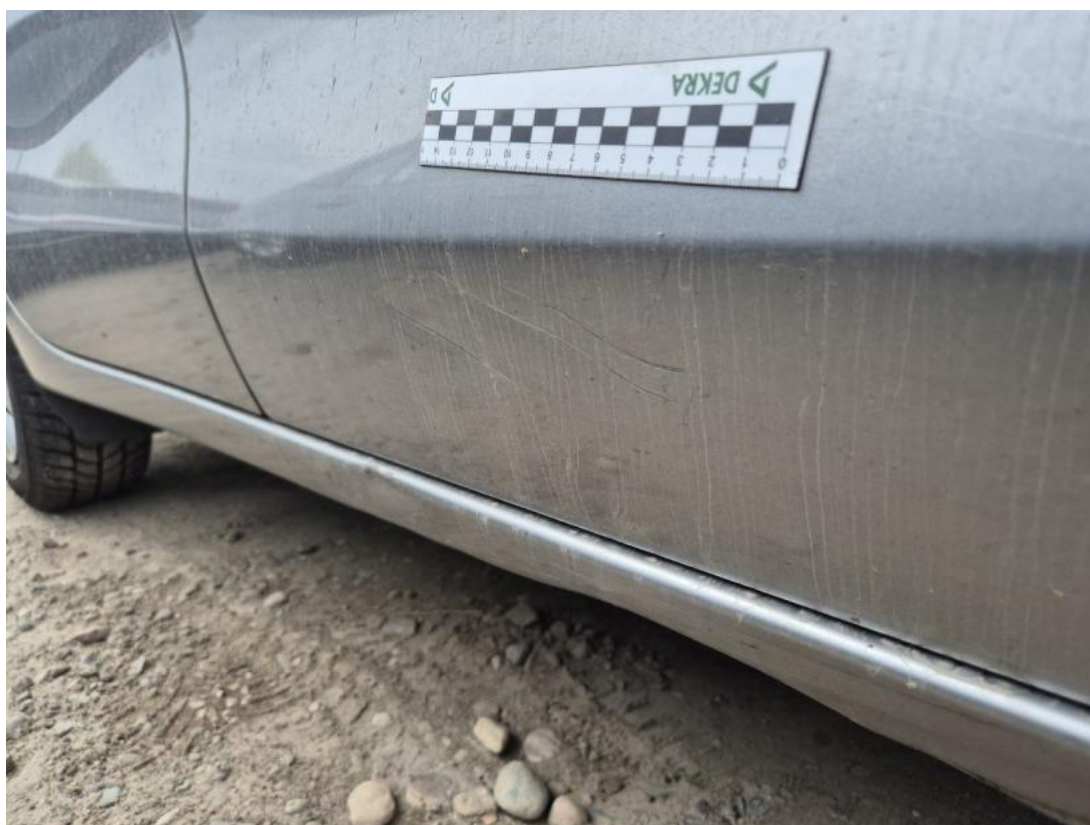
Fot. 41 Drzwi przednie P - Wgniecenie/odkształcenie 1
