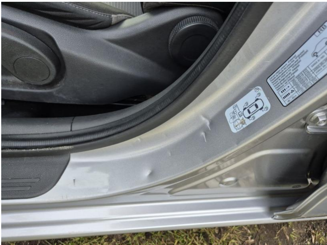
Fot. 48 Słupek środkowy L - Wgniecenie/odkształcenie 1
