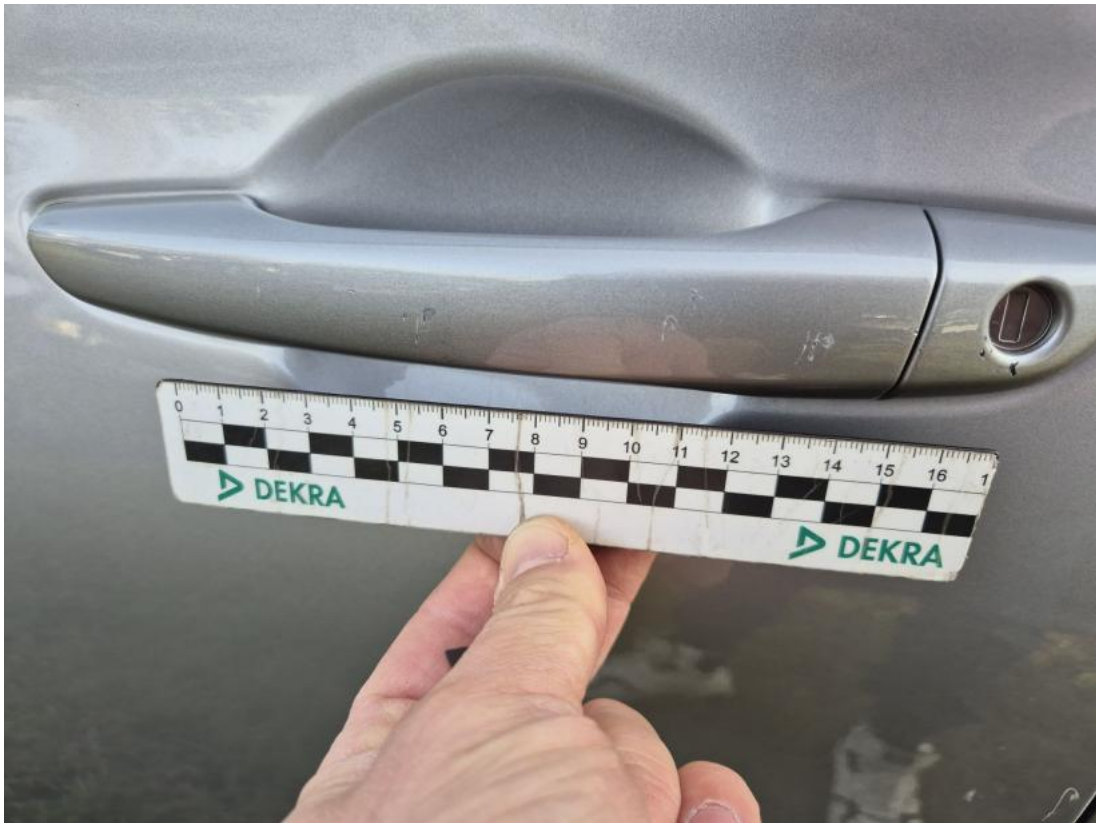
Fot. 47 Kłamka drzwi prz L - Rysa/odprysk 1
