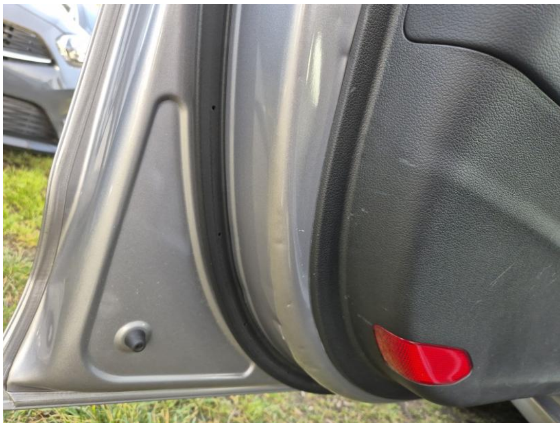
Fot. 45 Drzwi przed L - Wgniecenie/odkształcenie 1
