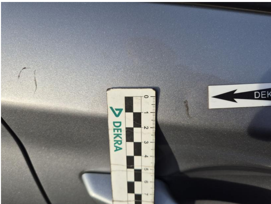
Fot. 34 Drzwi przednie P - Rysa/odprysk 1
