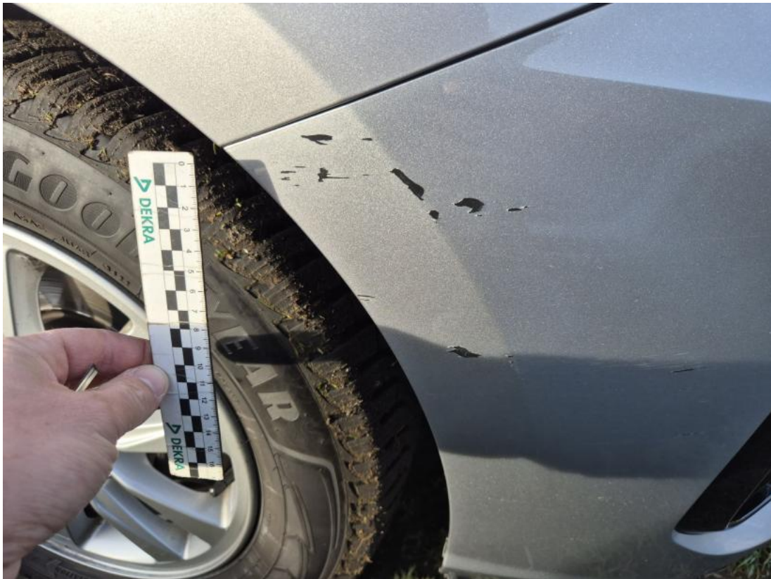
Fot. 33 Zderzak - Rysa/odprysk 1
