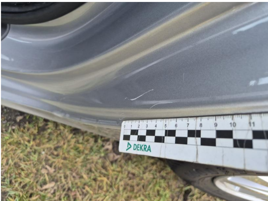
Fot. 42 Błotnik tylny L / Ściana boczna L - Rysa/odprysk 1
