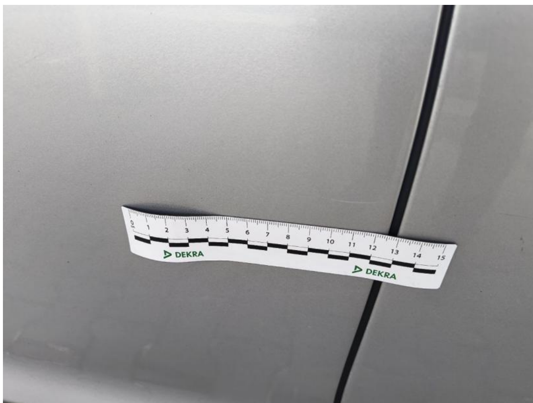
Fot. 46 Drzwi tylne P - Rysa/odprysk 1
