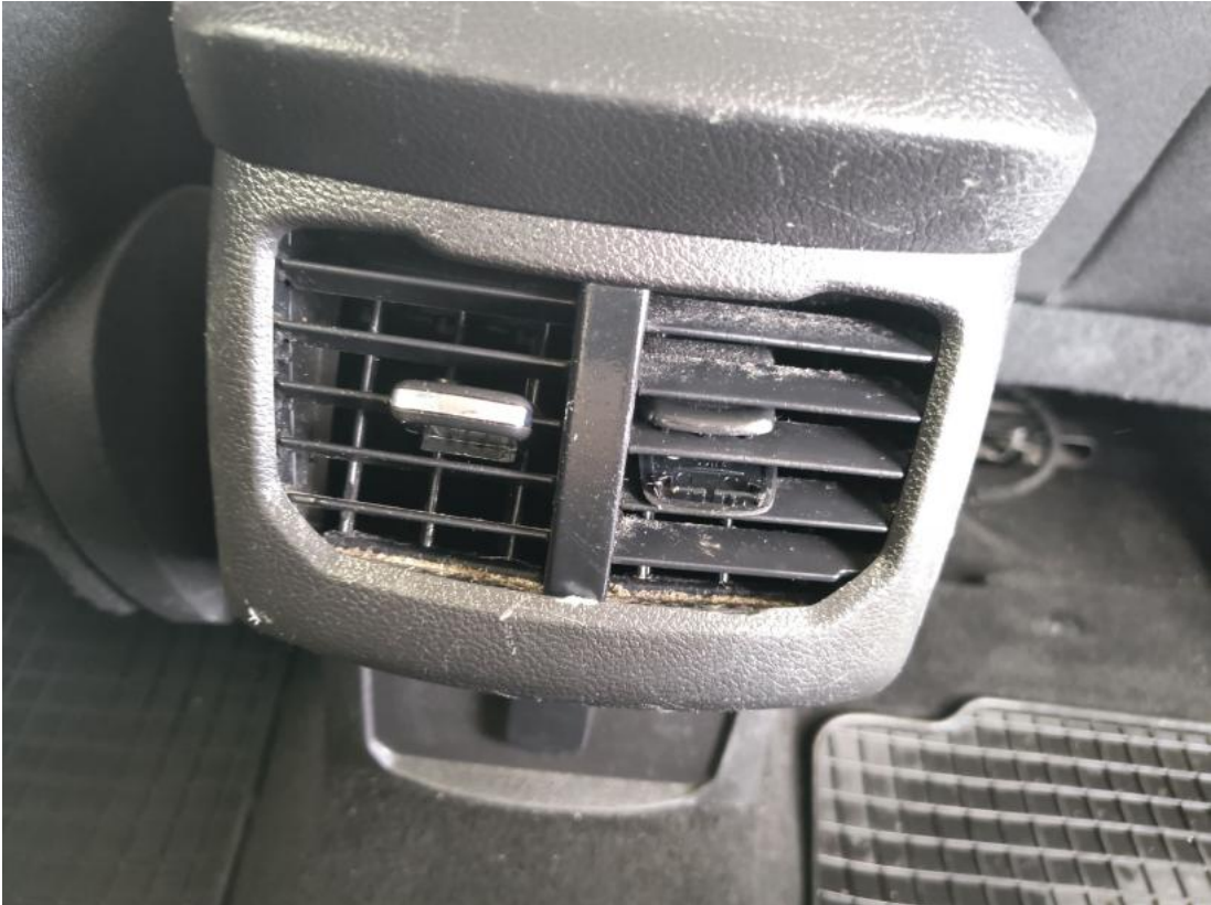
Fot. 67 Dysze nawiewu deski rozdzielczej - Pęknięcie/rozerwanie 1
