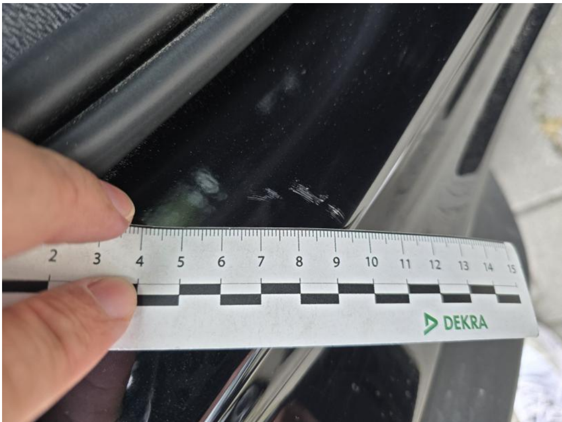
Fot. 51 Próg P - Rysa/odprysk 1
