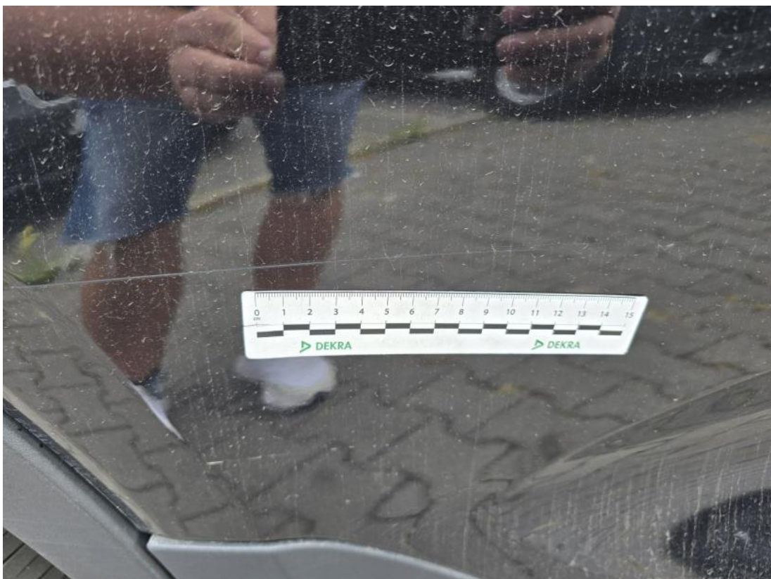
Fot. 50 Drzwi tylne P() - Rysa/odprysk 3
