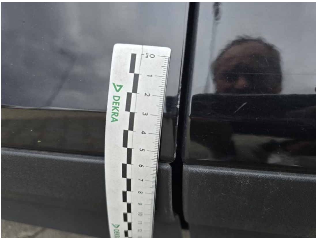
Fot. 52 Drzwi przed L - Rysa/odprysk 1
