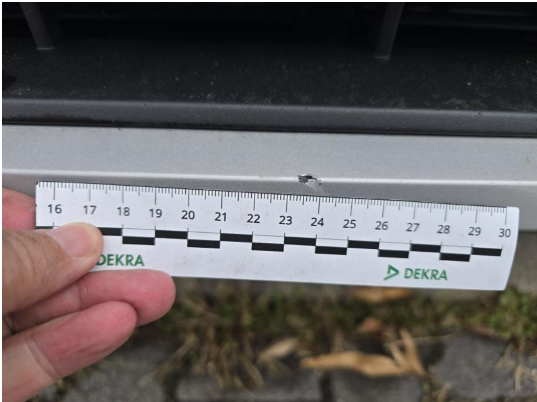
Fot. 39 Zderzak - Rysa/odprysk 1
