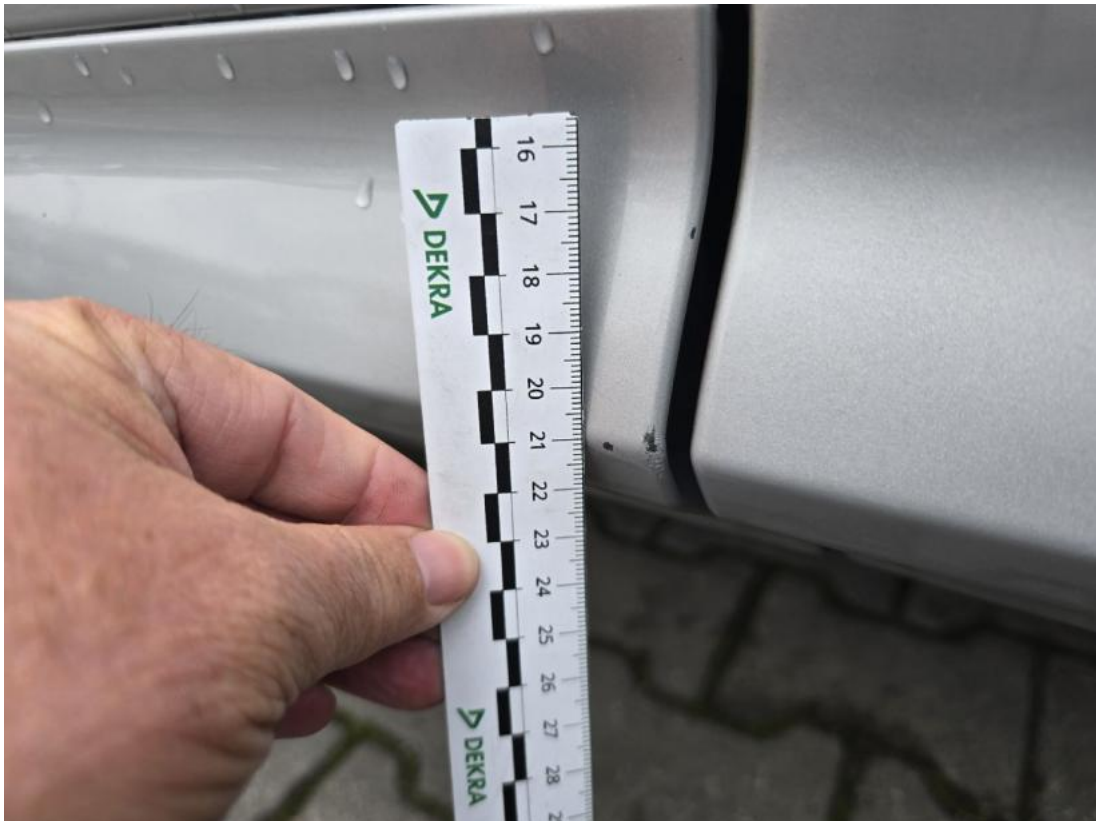
Fot. 43 Drzwi przed L - Rysa/odprysk 1
