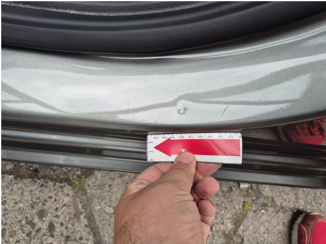
Fot. 65 Próg L - Wgniecenie/odkształcenie 2
