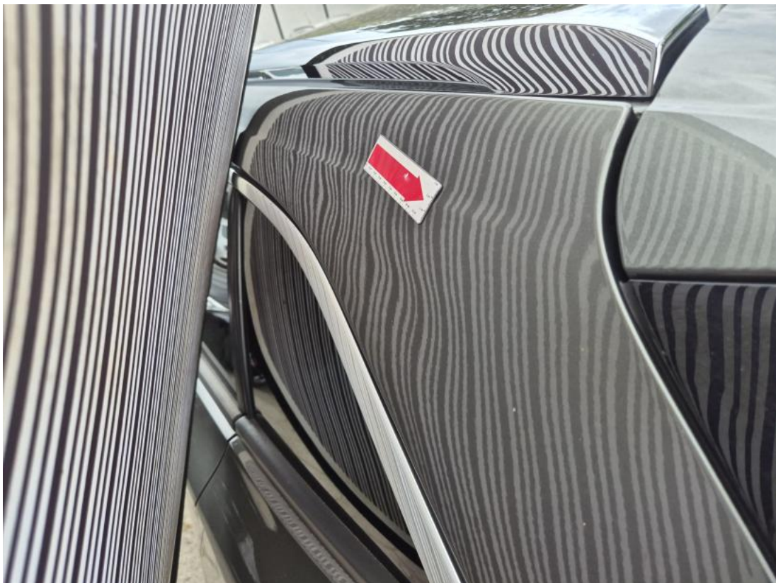
Fot. 58 Rama dachu L - Wgniecenie/odkształcenie 1
