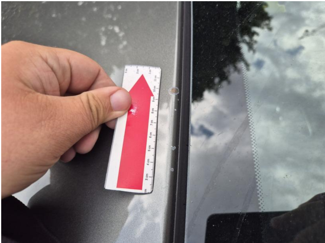
Fot. 55 Dach - Rysa/odprysk 1
