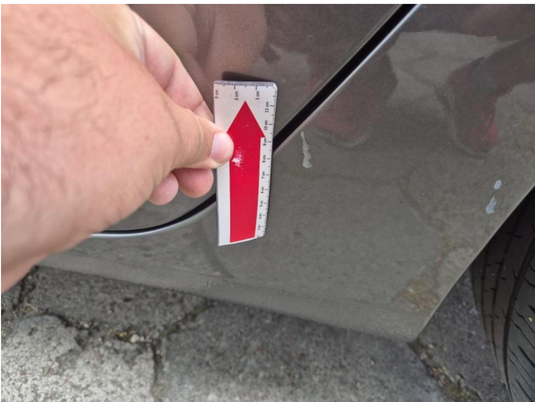
Fot. 64 Próg L - Wgniecenie/odkształcenie 1
