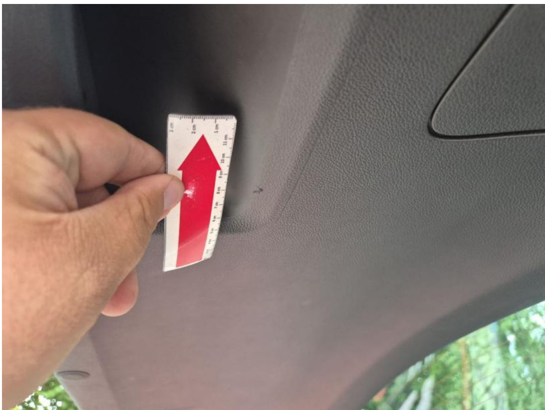
Fot. 74 Wykładzina pokrywy tylnej - Rysa/odprysk 1
