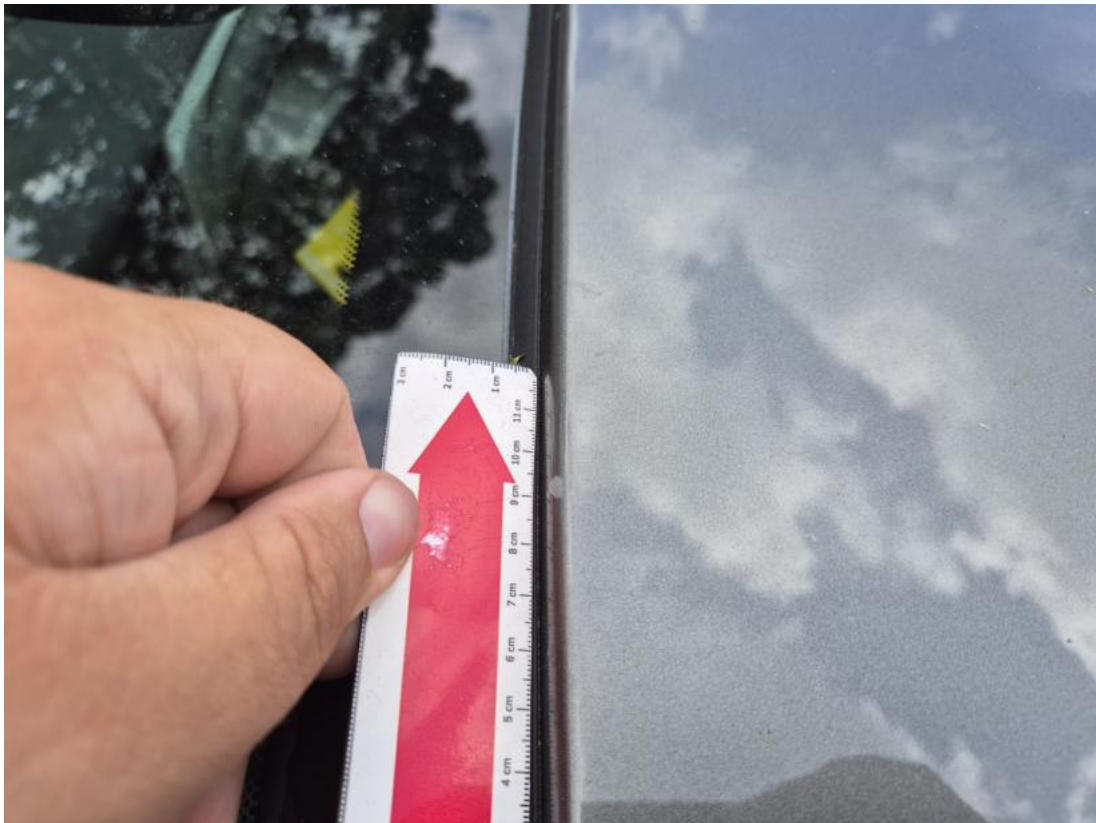
Fot. 57 Dach() - Rysa/odprysk 3
