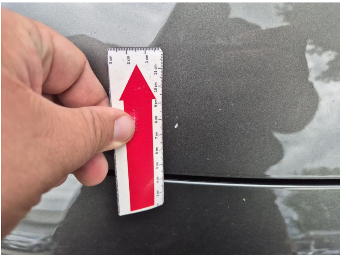
Fot. 38 Pokrywa komory silnika - Rysa/odprysk 1
