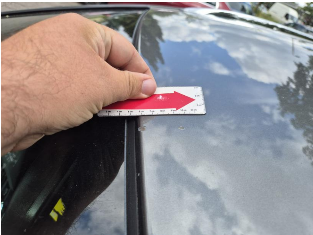
Fot. 56 Dach - Rysa/odprysk 2
