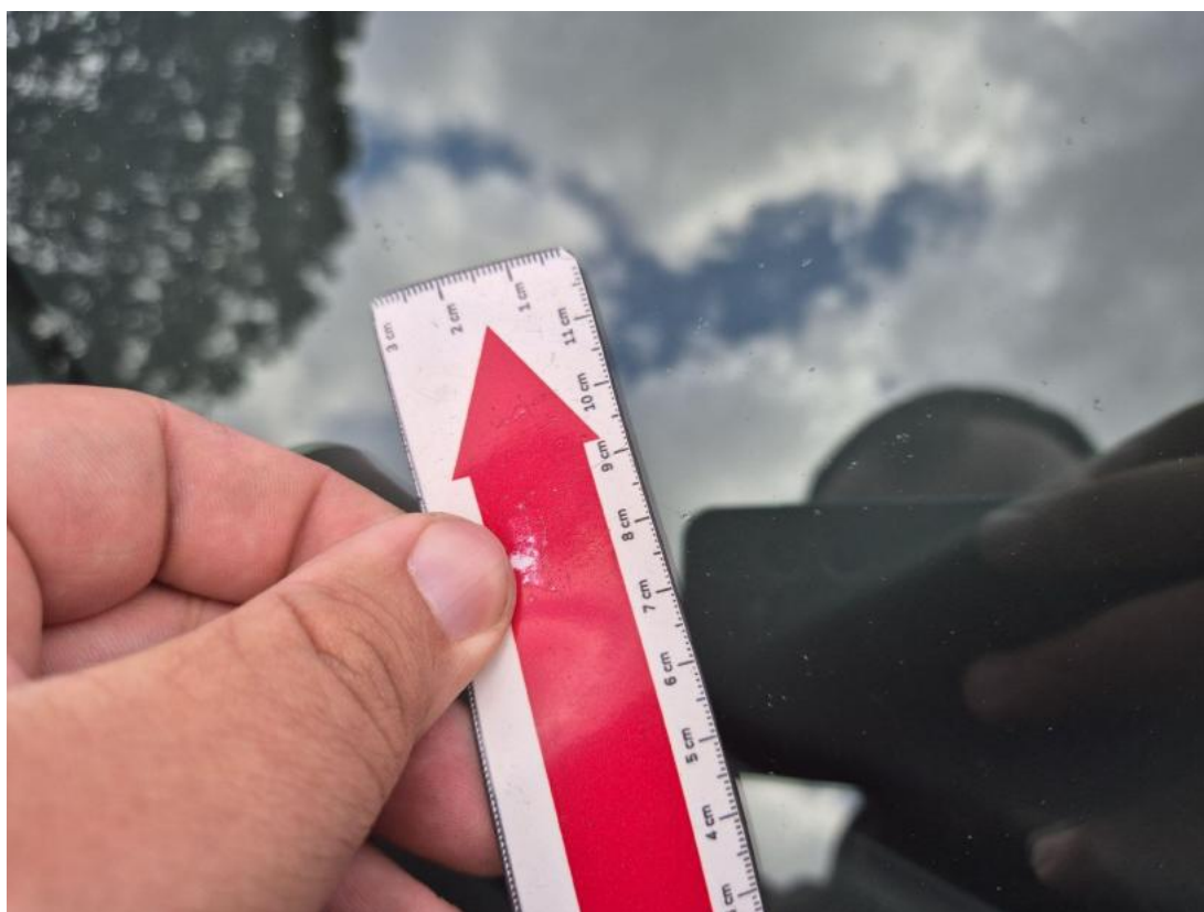
Fot. 40 Szyba czołowa - Rysa/odprysk 1
