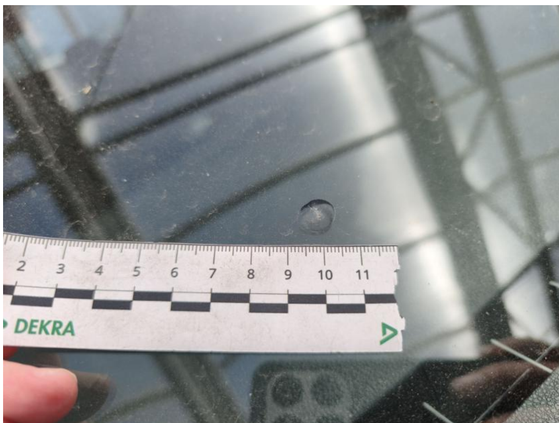
Fot. 40 Szyba czołowa - Pęknięcie/rozerwanie 1
