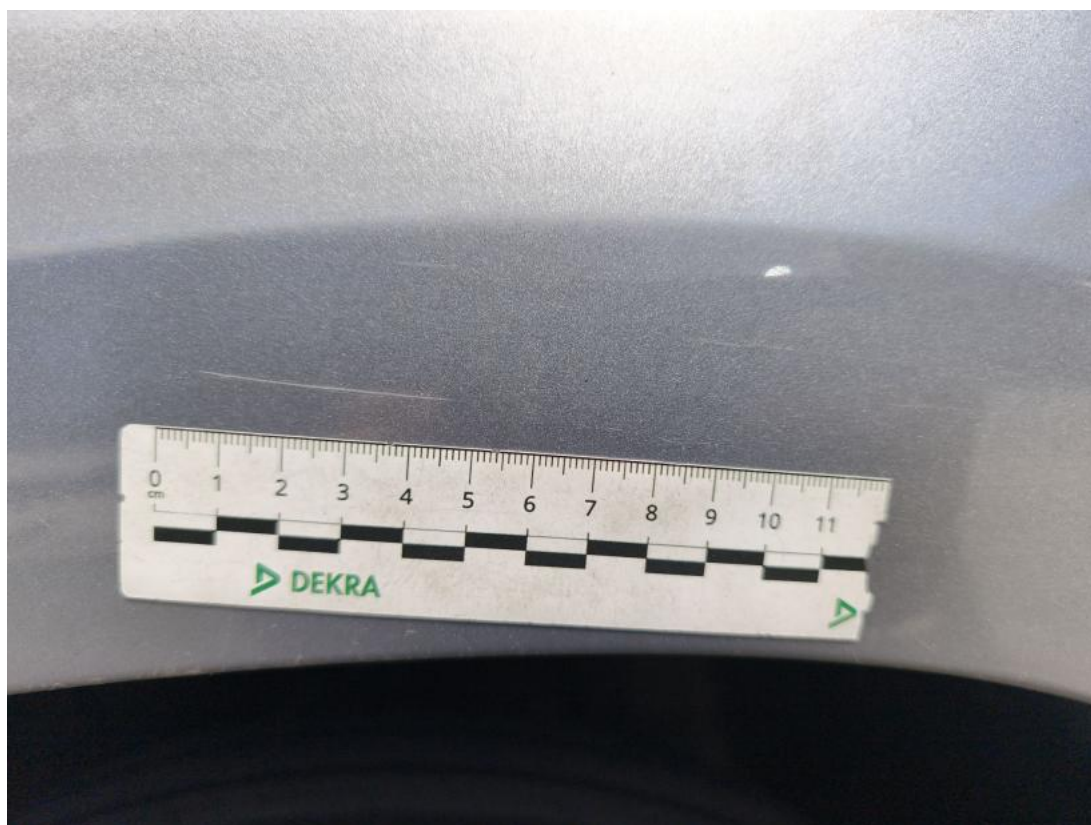
Fot. 52 Błotnik przedni L - Rysa/odprysk 1
