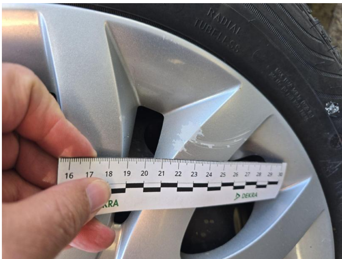
Fot. 37 Kołpak tylny P - Rysa/odprysk 1
