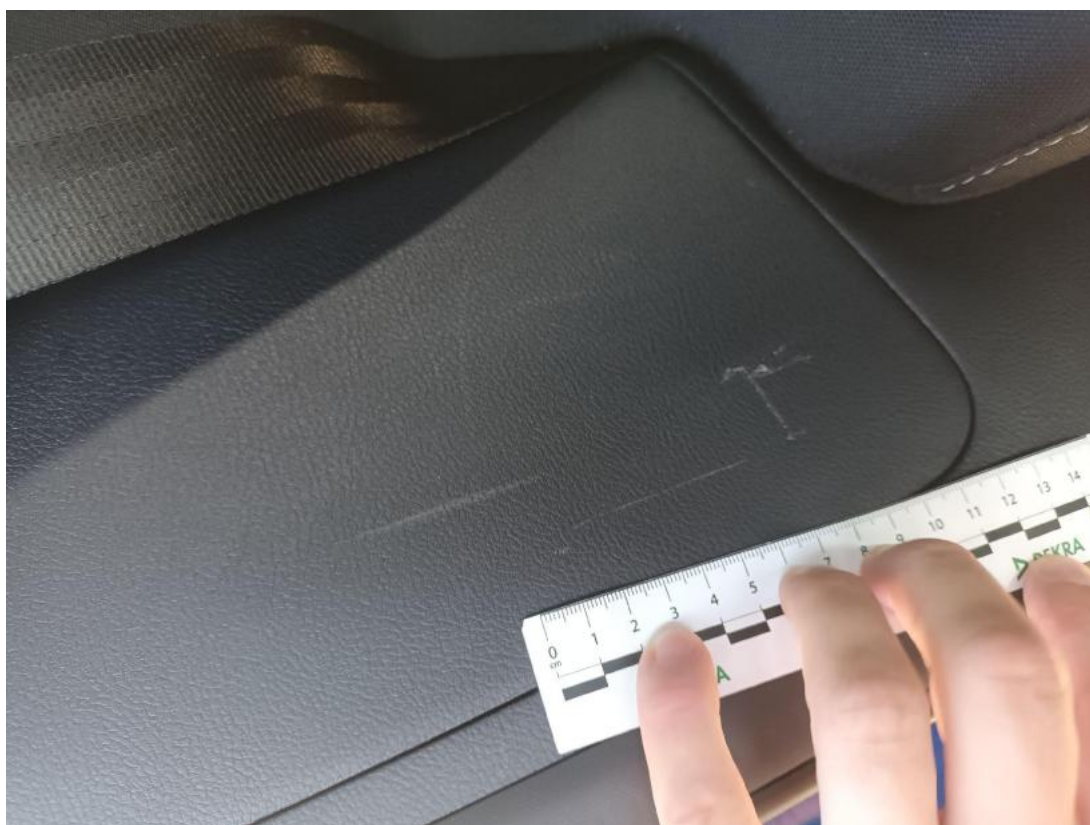
Fot. 44 Listwy progowe praw. - Rysa/odprysk 1
