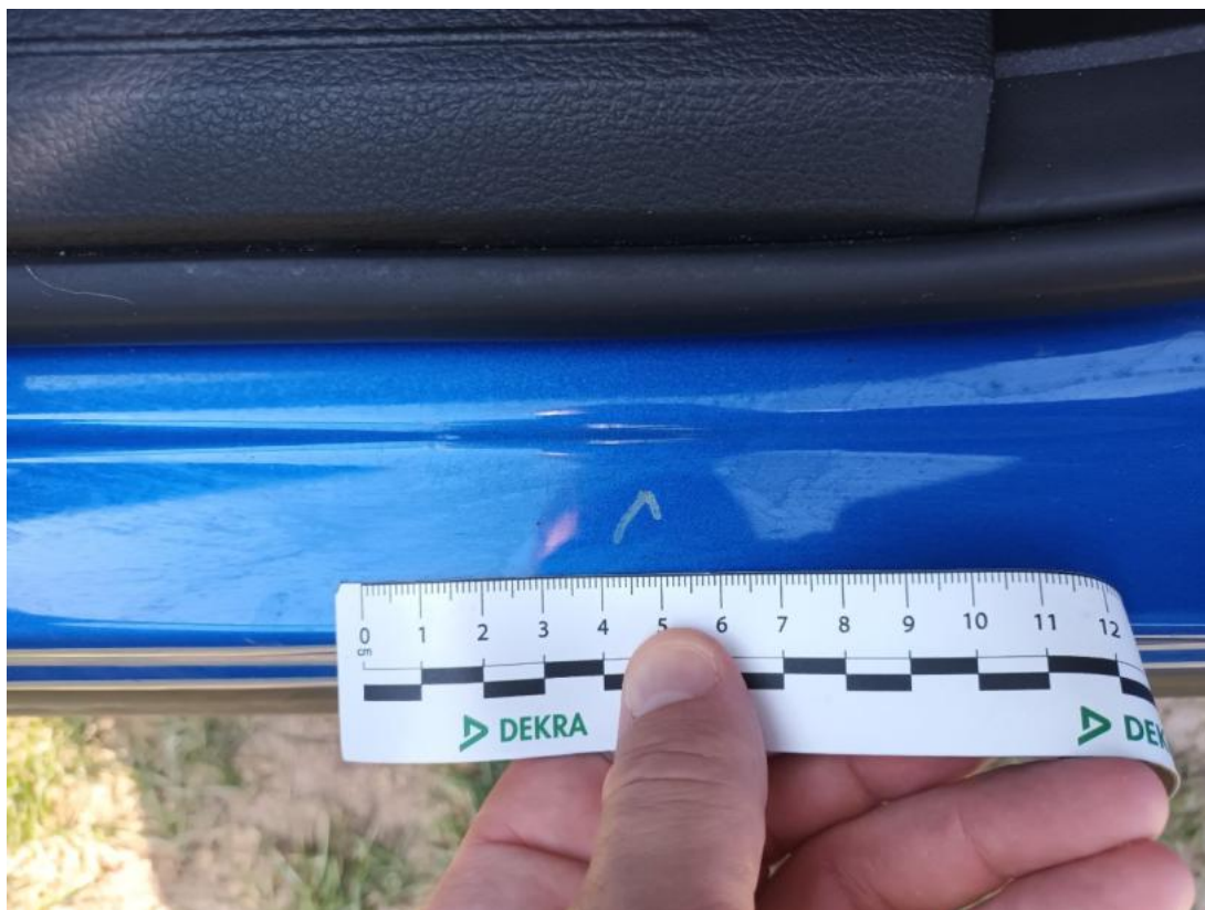
Fot. 43 Próg L - Rysa/odprysk 1
