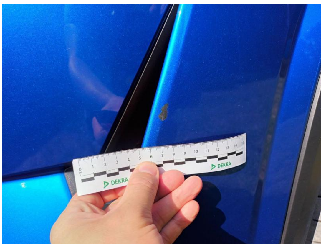
Fot. 40 Zderzak przedni cz L - Rysa/odprysk 1
