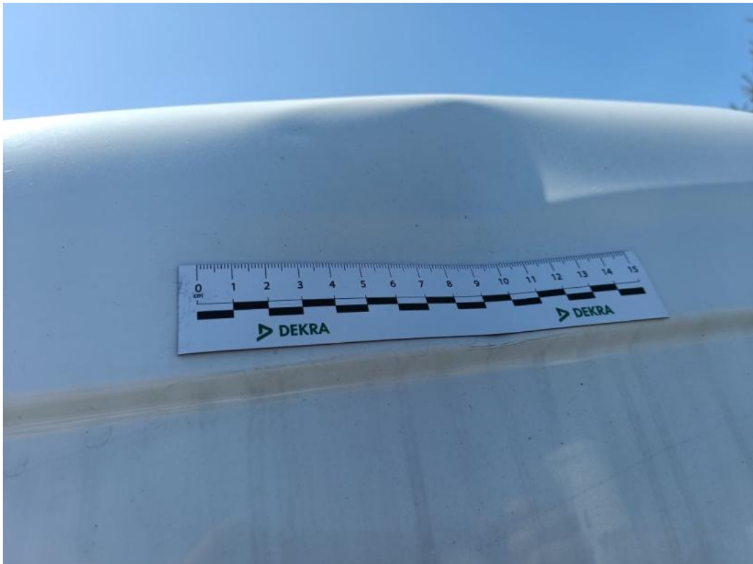
Fot. 69 Drzwi tylne L - Wgniecenie/odkształcenie 1
