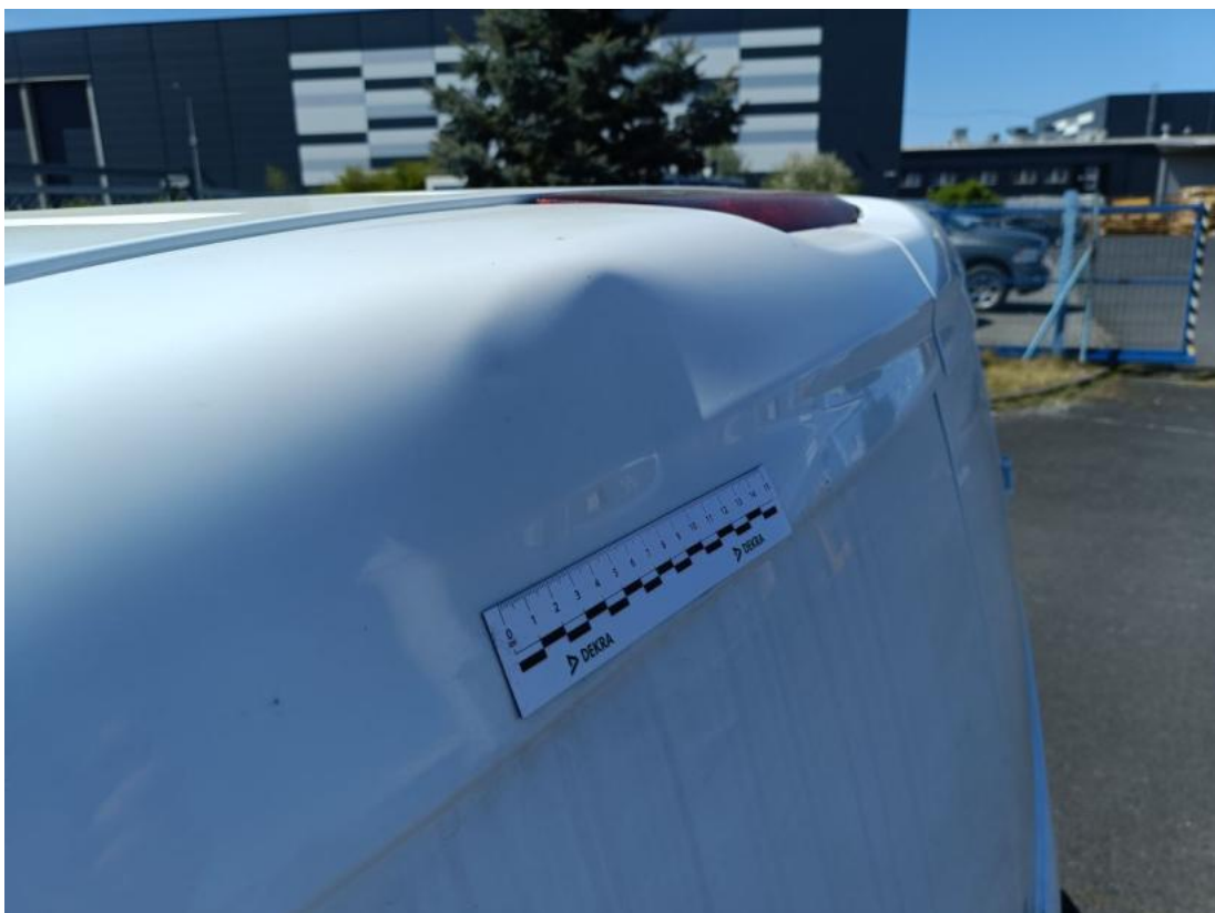
Fot. 70 Drzwi tylne L - Wgniecenie/odkształcenie 2
