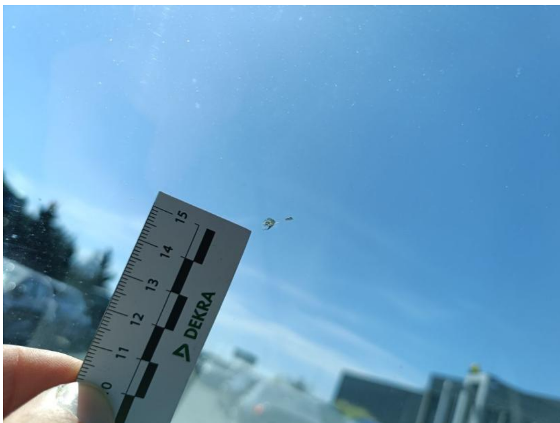
Fot. 42 Szyba czołowa - Rysa/odprysk 2
