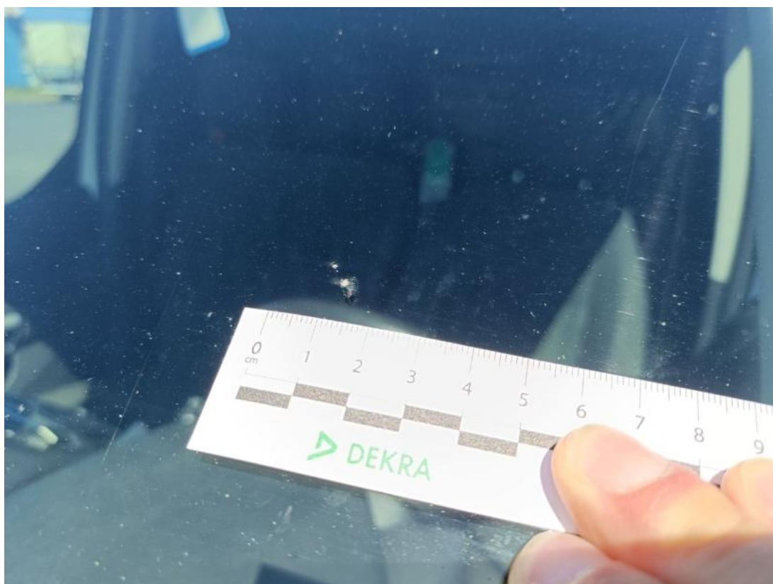
Fot. 41 Szyba czołowa - Rysa/odprysk 1
