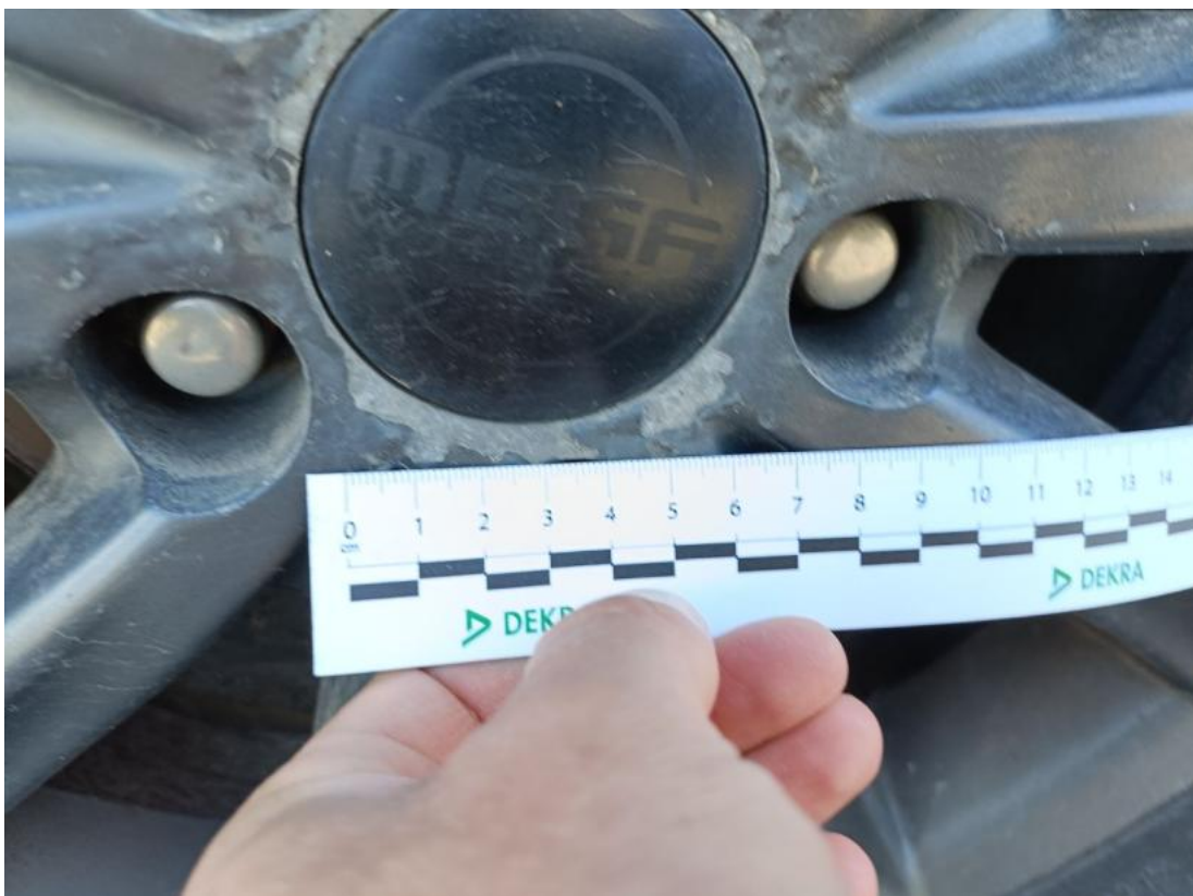
Fot. 60 Felga aluminiowa tylna P - Rysa/odprysk 1
