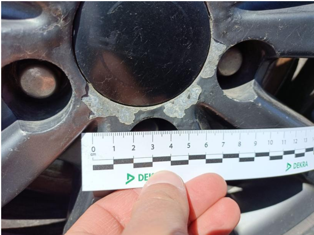
Fot. 73 Felga Aluminiowa przednia L - Rysa/odprysk 1
