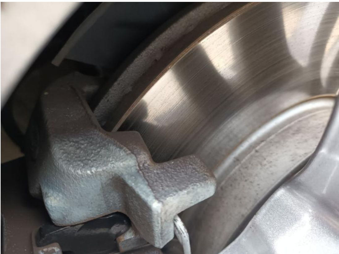
Fot. 28 Tarcza hamulcowa przednia lewa
