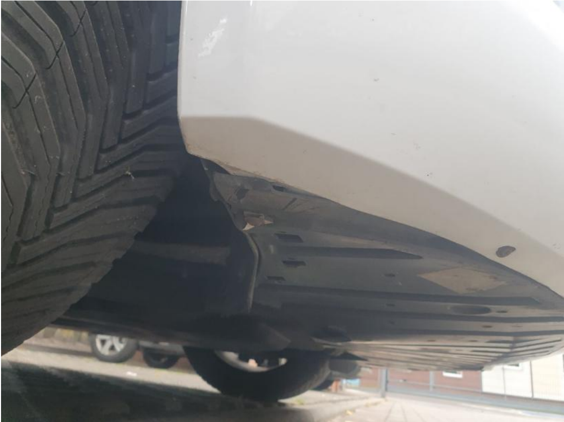
Fot. 49 Zderzak() - Pęknięcie/rozerwanie 3
