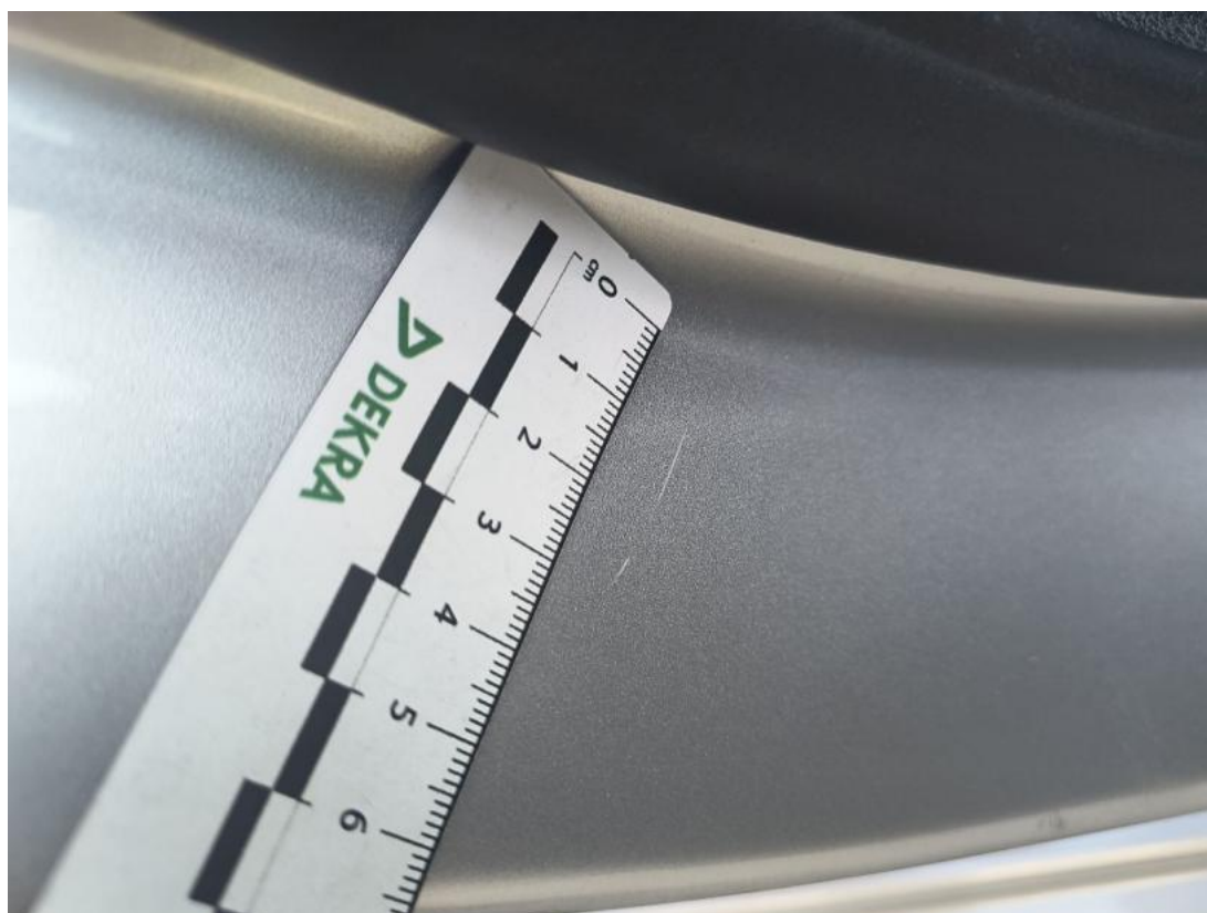
Fot. 54 Próg P - Rysa/odprysk 2
