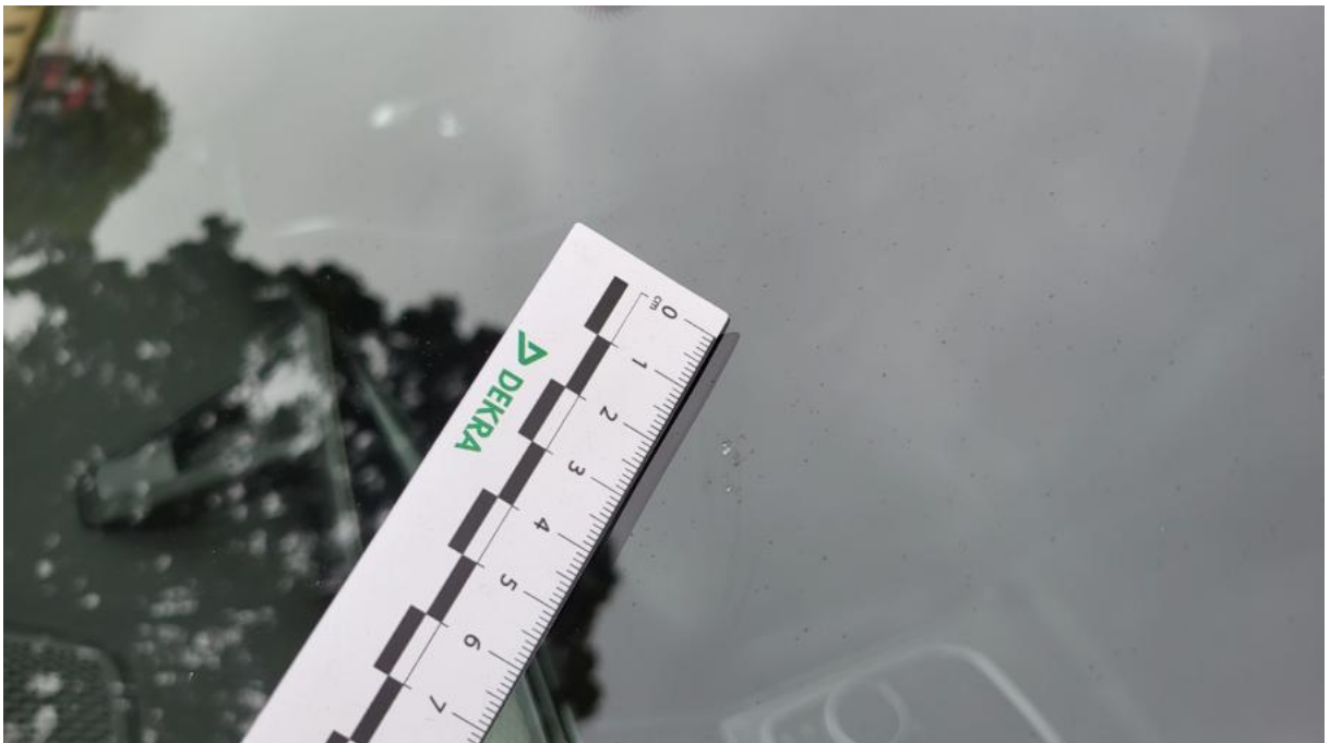
Fot. 32 Szyba czołowa - Rysa/odprysk 1
