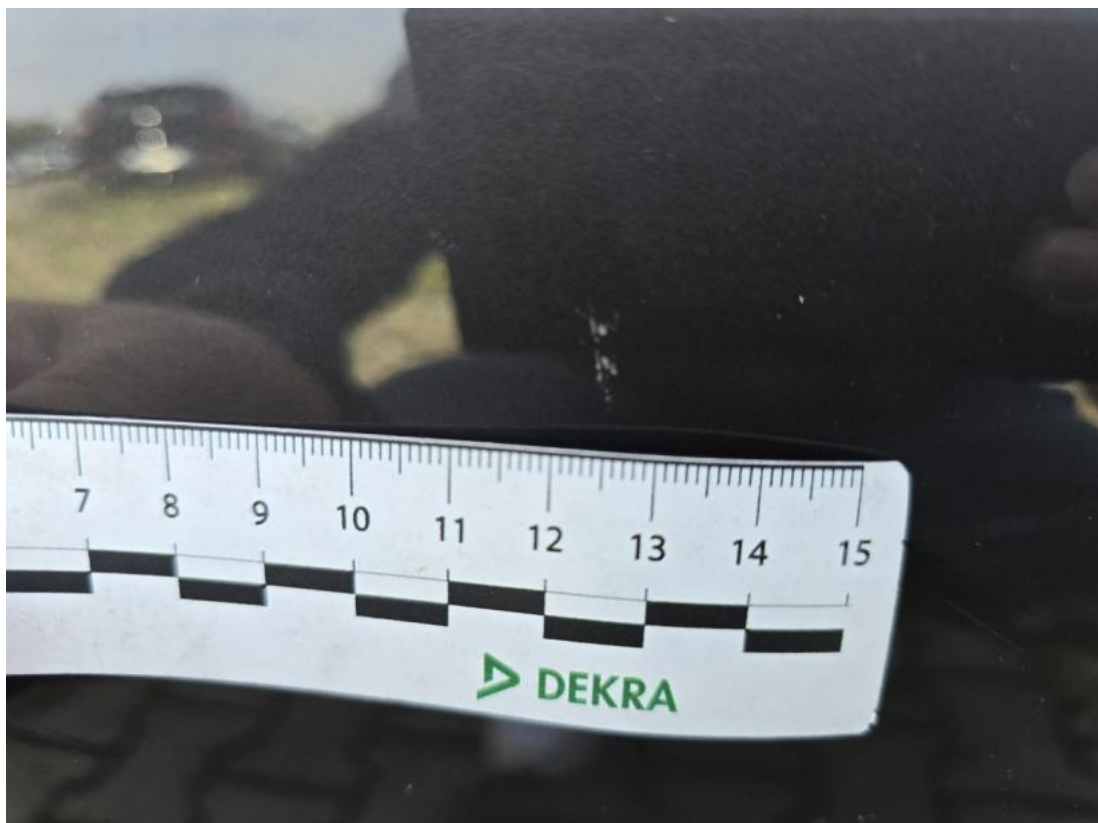
Fot. 38 Drzwi przednie P - Rysa/odprysk 1
