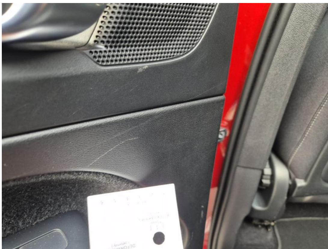
Fot. 62 Tapicerka drzwi tylnych L - Rysa/odprysk 1
