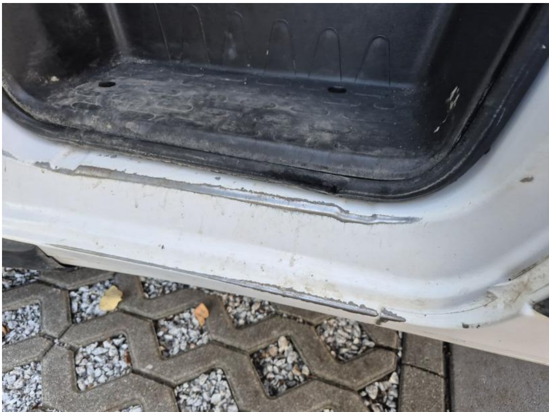
Fot. 44 Próg L - Rysa/odprysk 1
