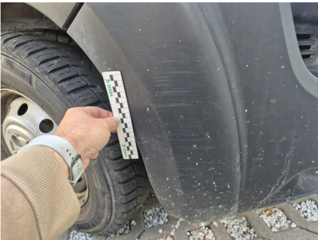
Fot. 36 Listwa błotnika przedniego P - Rysa/odprysk 1
