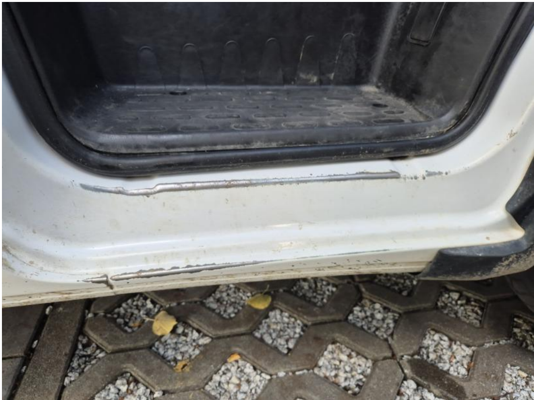
Fot. 41 Próg P - Rysa/odprysk 1
