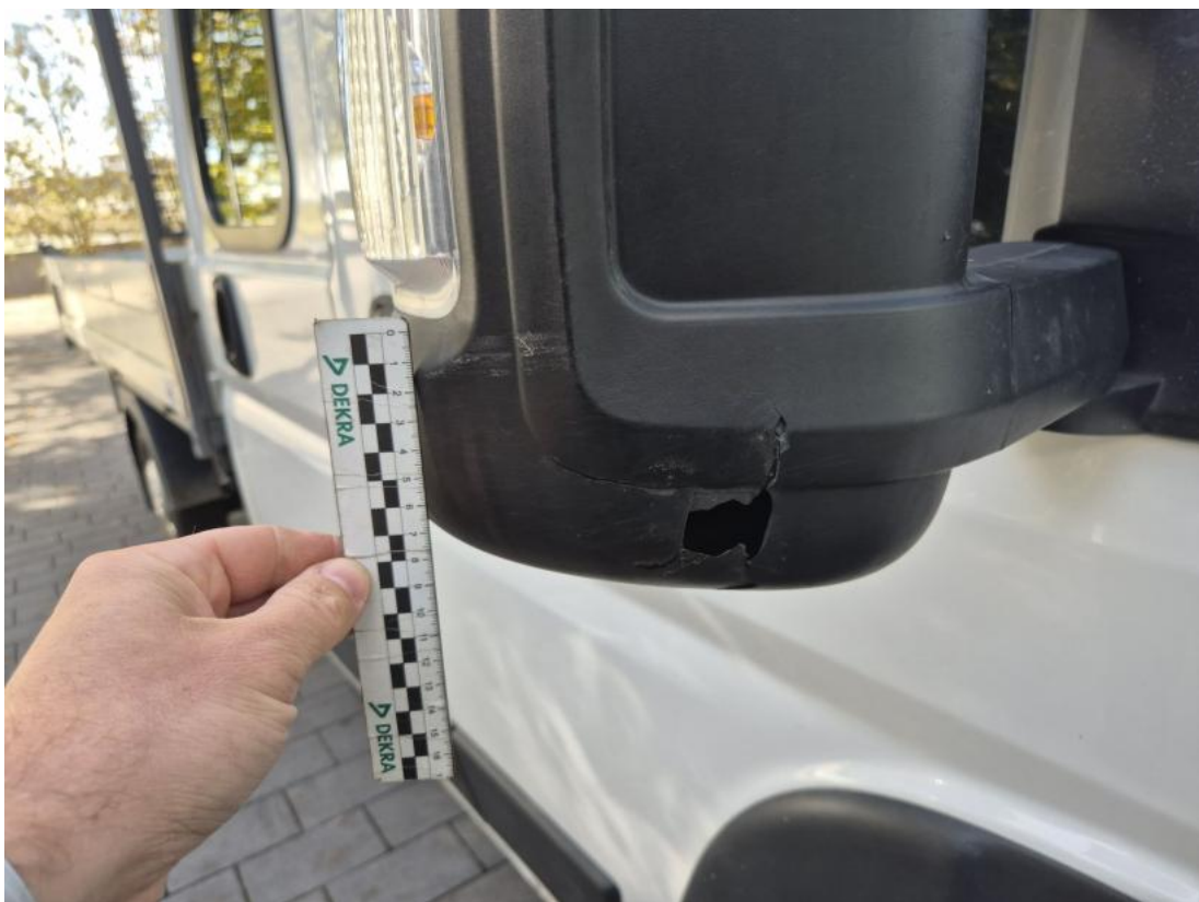
Fot. 40 Obudowa lusterka zew P - Pęknięcie/rozerwanie 1
