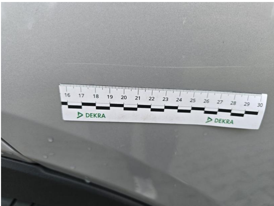
Fot. 42 Drzwi tylne P - Rysa/odprysk 1
