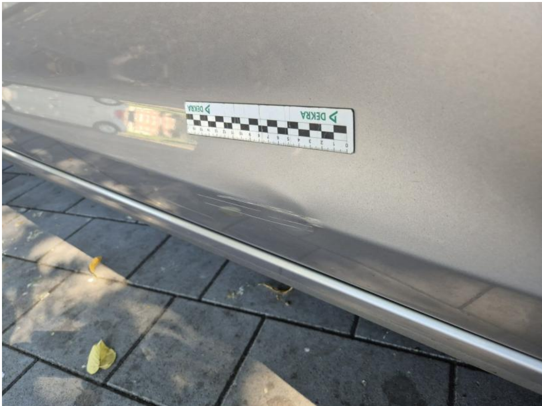
Fot. 35 Drzwi przednie P - Wgniecenie/odkształcenie 1
