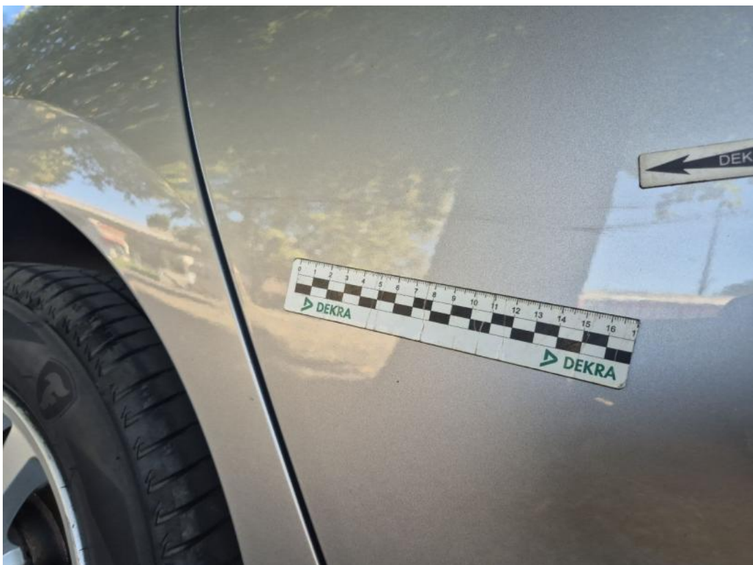
Fot. 36 Drzwi tylne P - Rysa/odprysk 1
