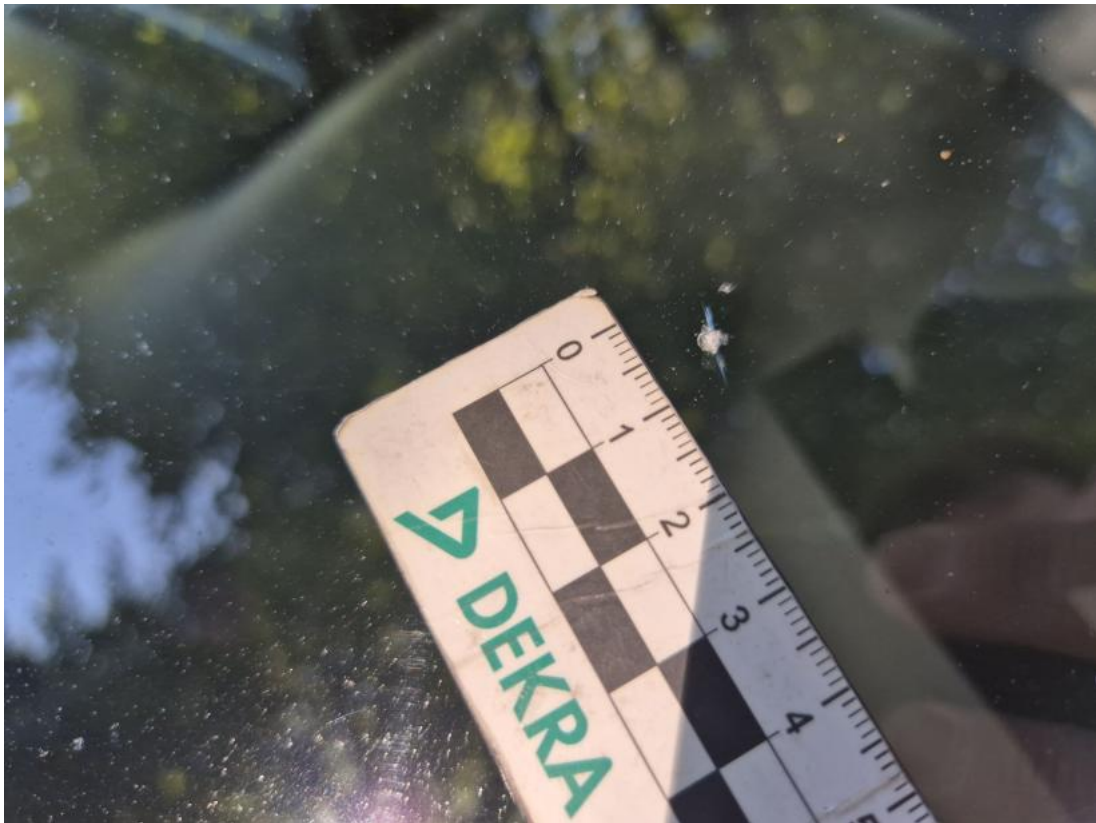
Fot. 33 Szyba czołowa - Pęknięcie/rozerwanie 1
