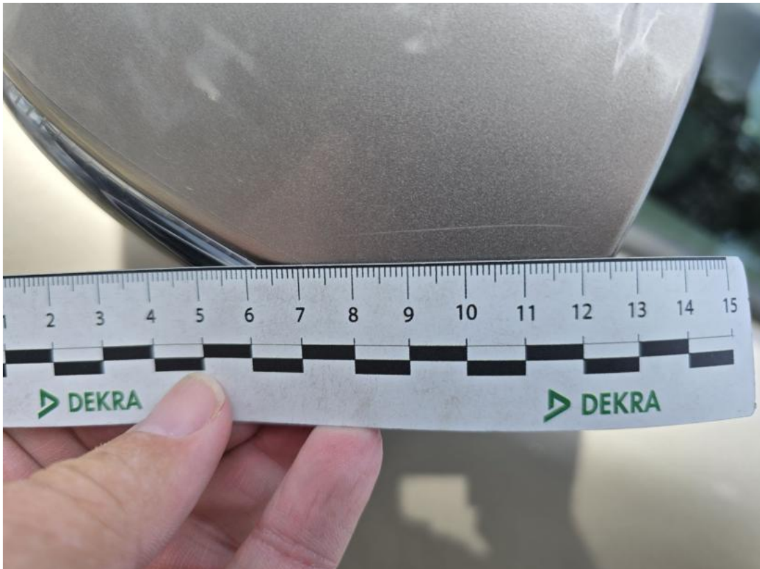
Fot. 45 Obudowa lusterka zew L - Rysa/odprysk 1
