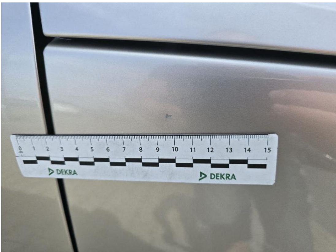
Fot. 40 Błotnik przedni P - Rysa/odprysk 1
