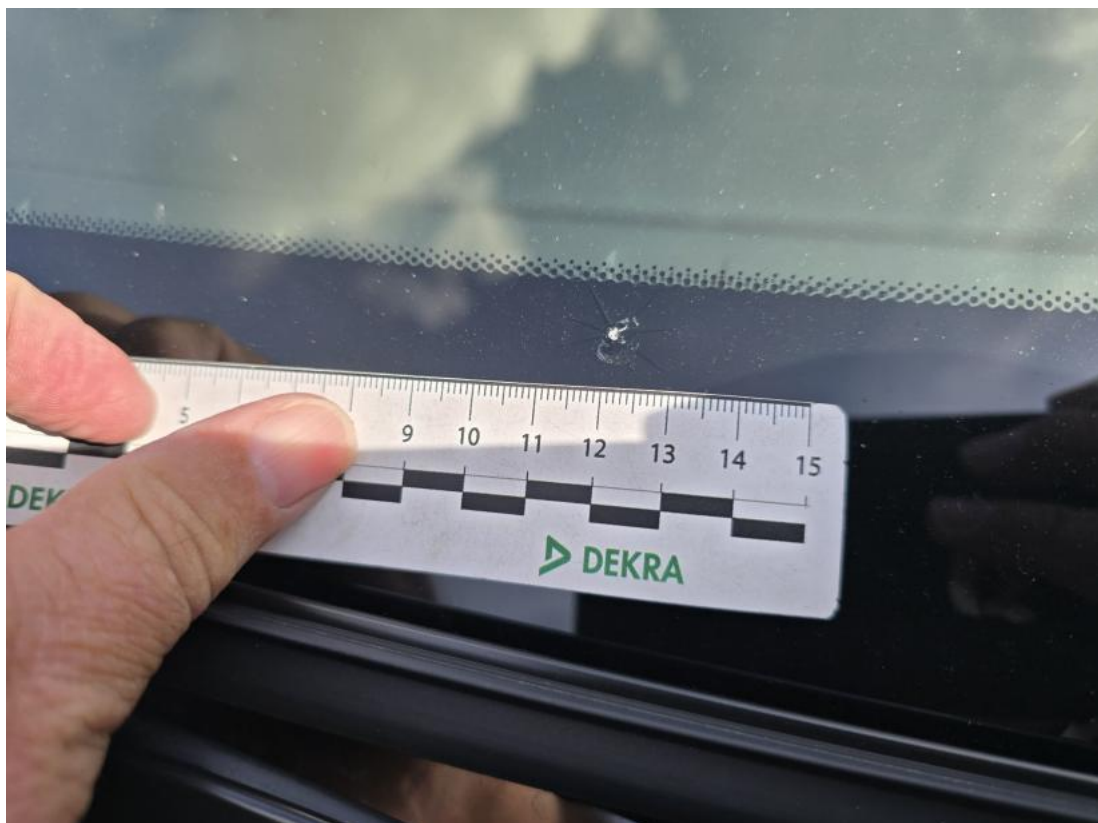
Fot. 38 Szyba czołowa - Rysa/odprysk 1
