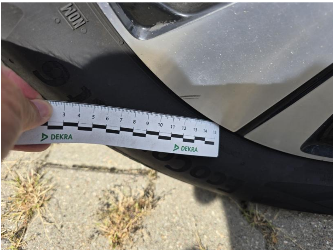
Fot. 46 Felga Aluminiowa przednia L - Rysa/odprysk 1
