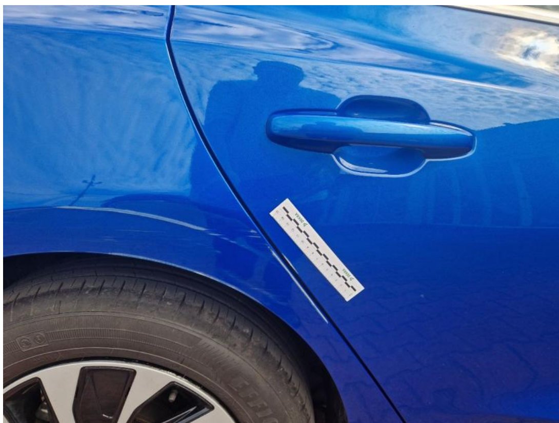
Fot. 39 Drzwi tylne P - Rysa/odprysk 1
