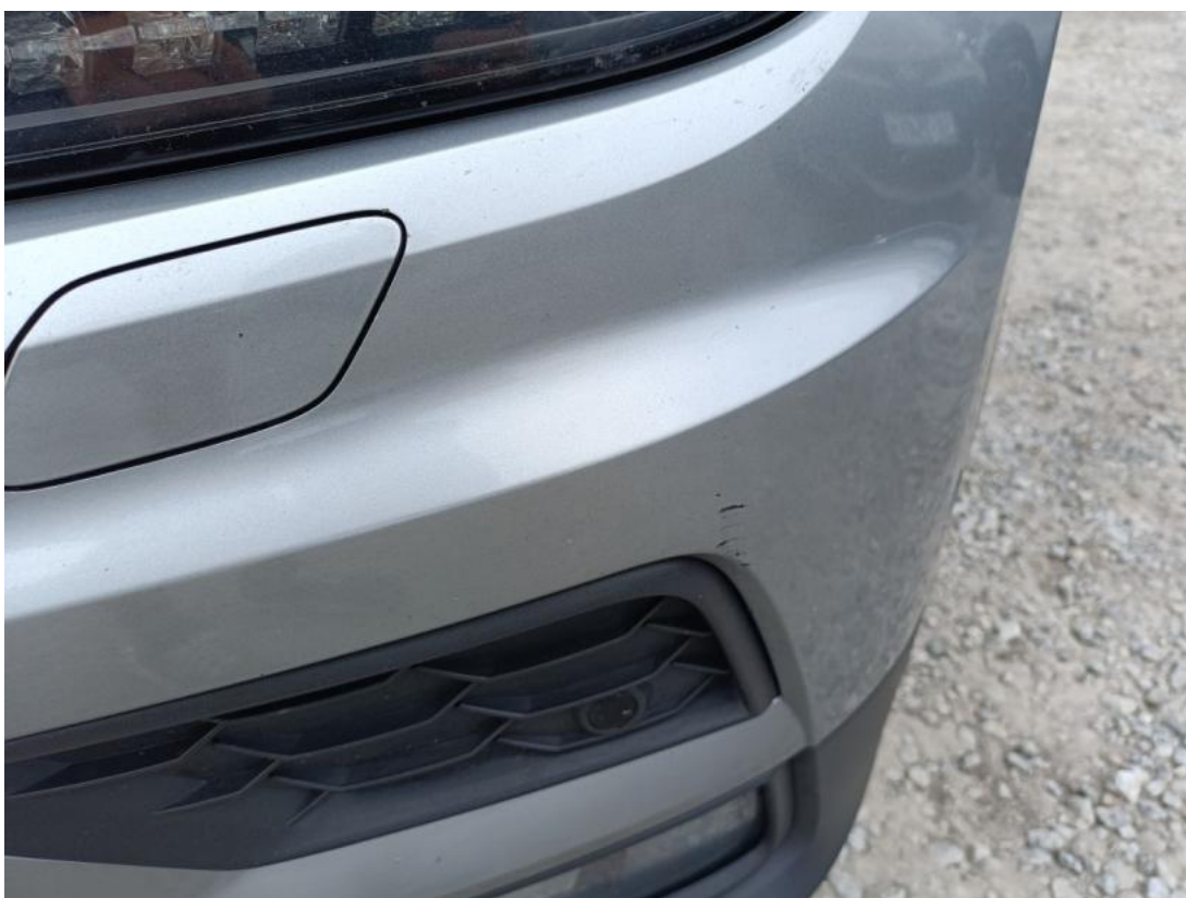
Fot. 58 Zderzak() - Rysa/odprysk 3
