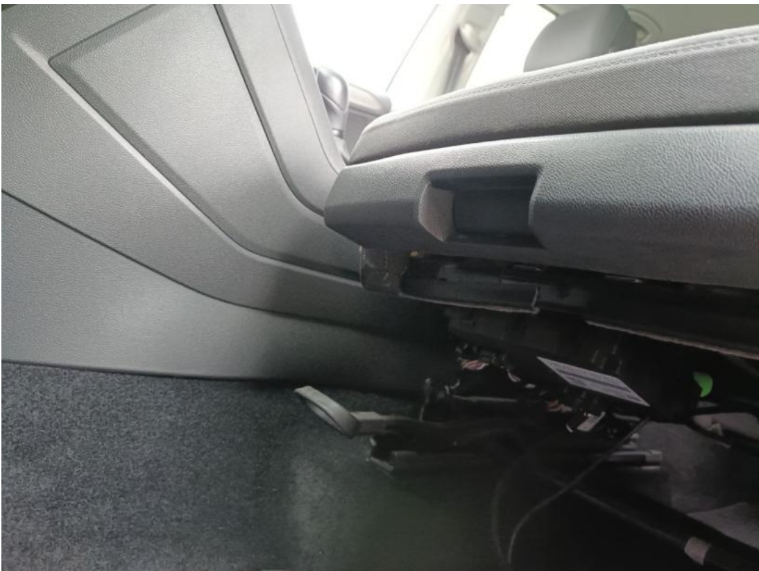
Fot. 48 niesprawny mechanizm regulacji długości siedziska fotela kierowcy
