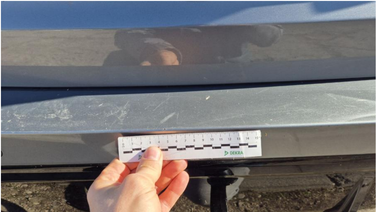
Fot. 37 Zderzak tylny - Rysa/odprysk 2
