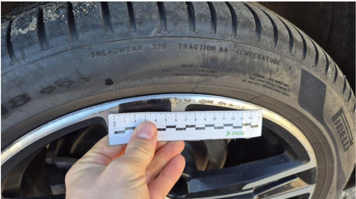
Fot. 38 Felga tylna L - Rysa/odprysk 1
