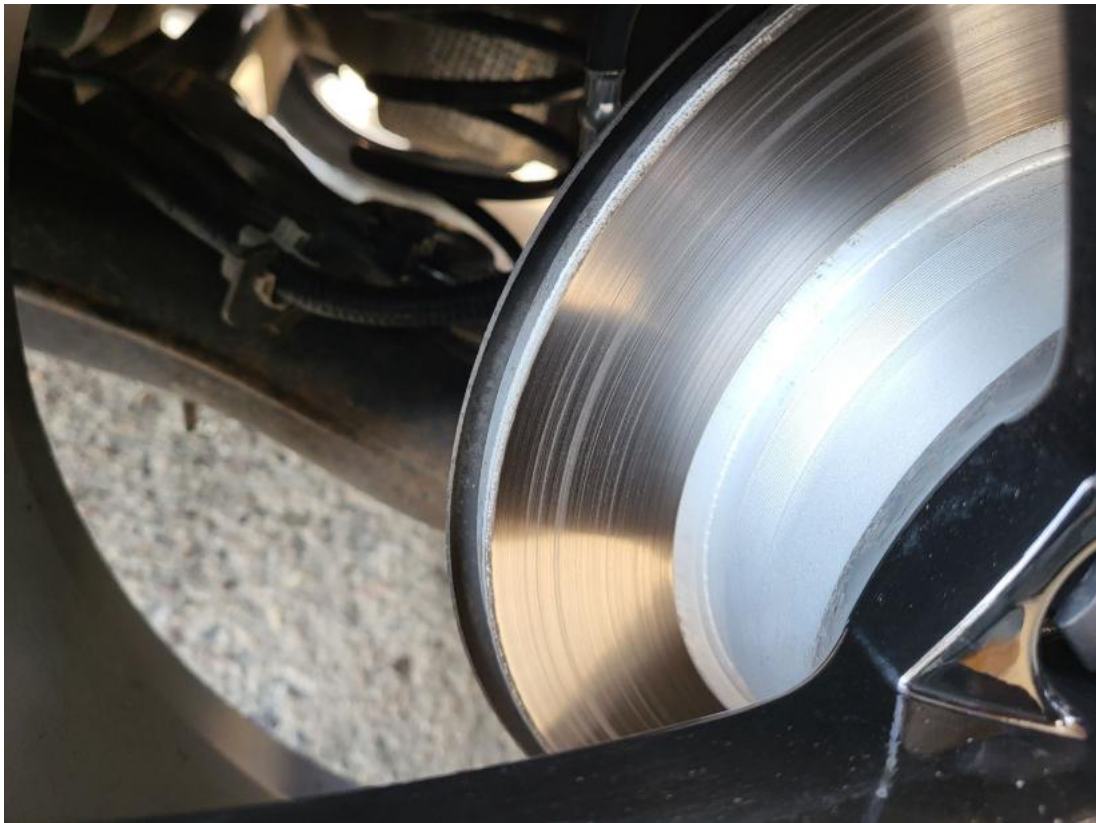
Fot. 31 Tarcza hamulcowa tylna lewa
