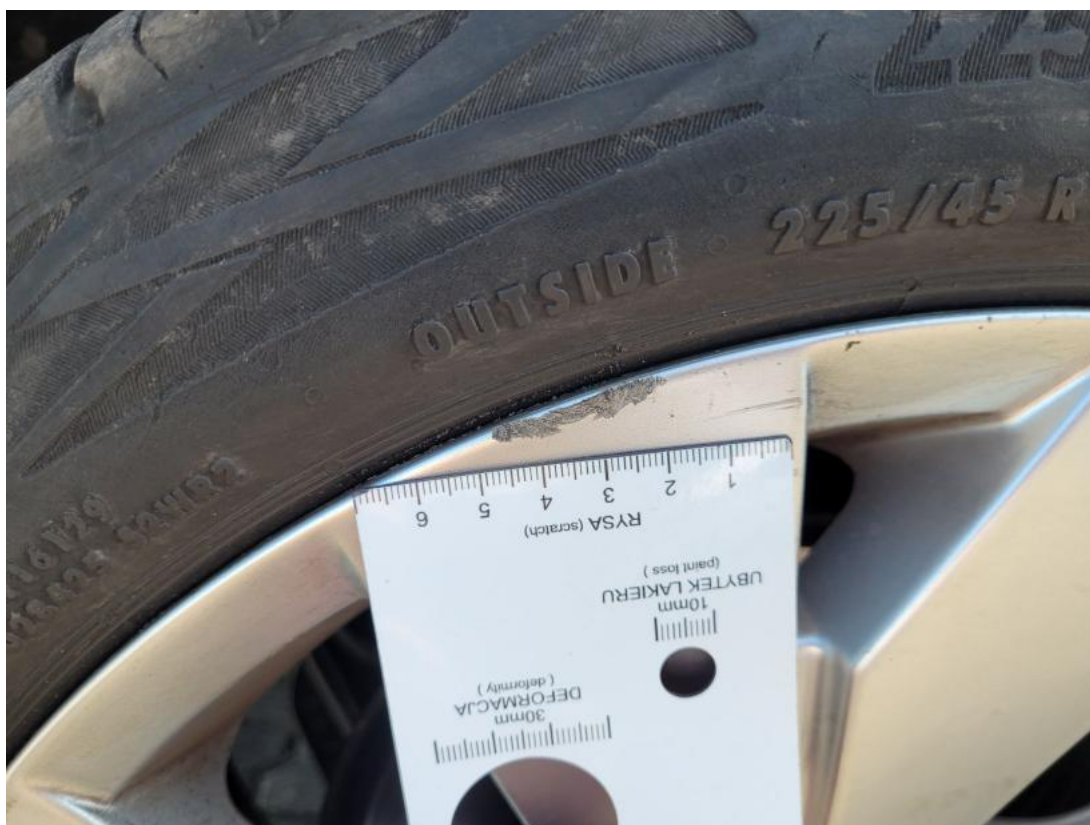
Fot. 36 Felga aluminiowa tylna P - Rysa/odprysk 1
