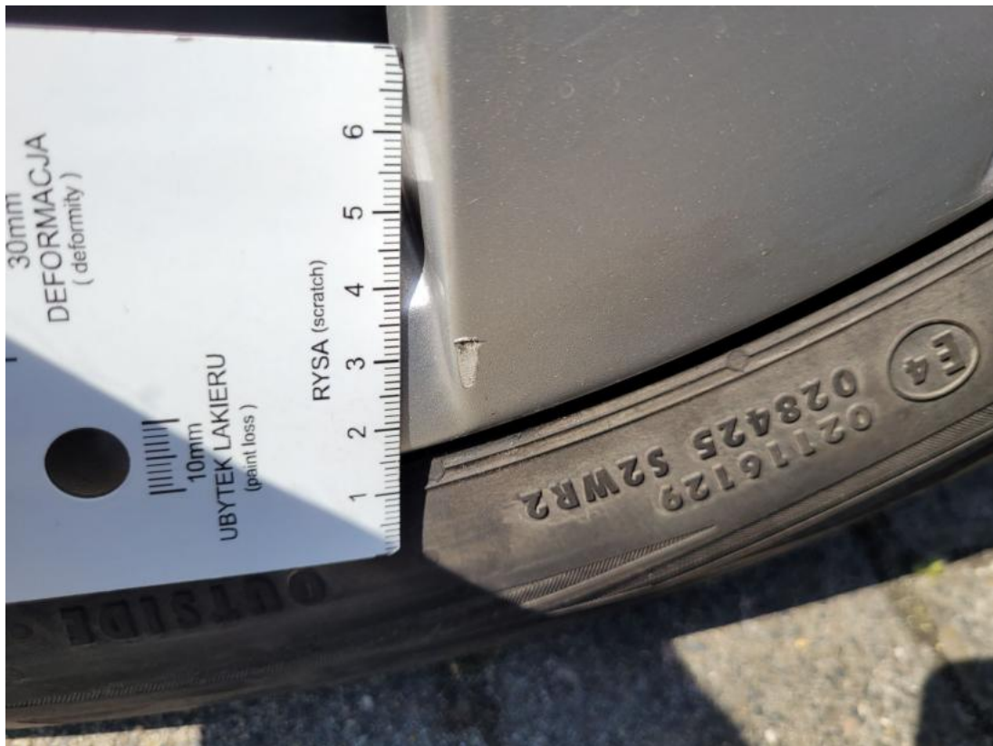
Fot. 41 Felga aluminiowa tylna L - Rysa/odprysk 1
