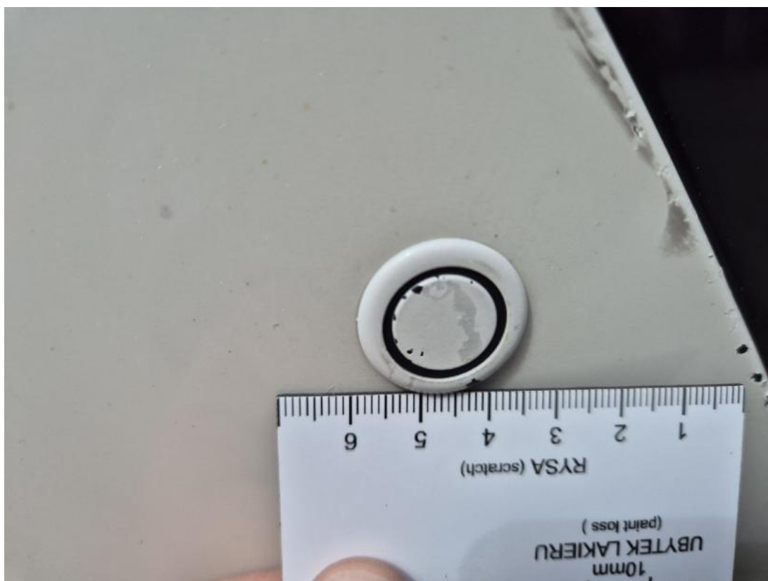
Fot. 42 Czujniki parkowania przód - Rysa/odprysk 2
