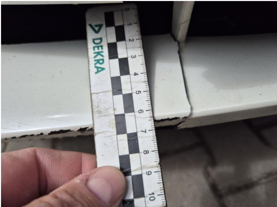
Fot. 47 Zderzak przedni cz dolna - Pęknięcie/rozerwanie 1
