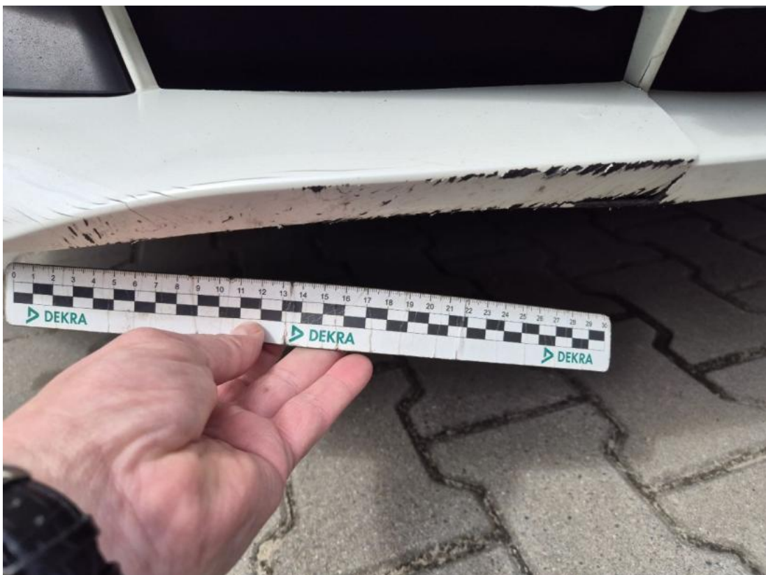
Fot. 48 Zderzak przedni cz dolna - Pęknięcie/rozerwanie 2
