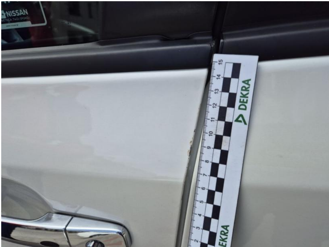
Fot. 57 Drzwi przed L() - Rysa/odprysk 3
