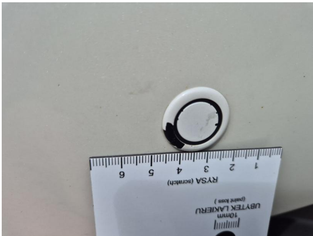
Fot. 41 Czujniki parkowania przód - Rysa/odprysk 1
