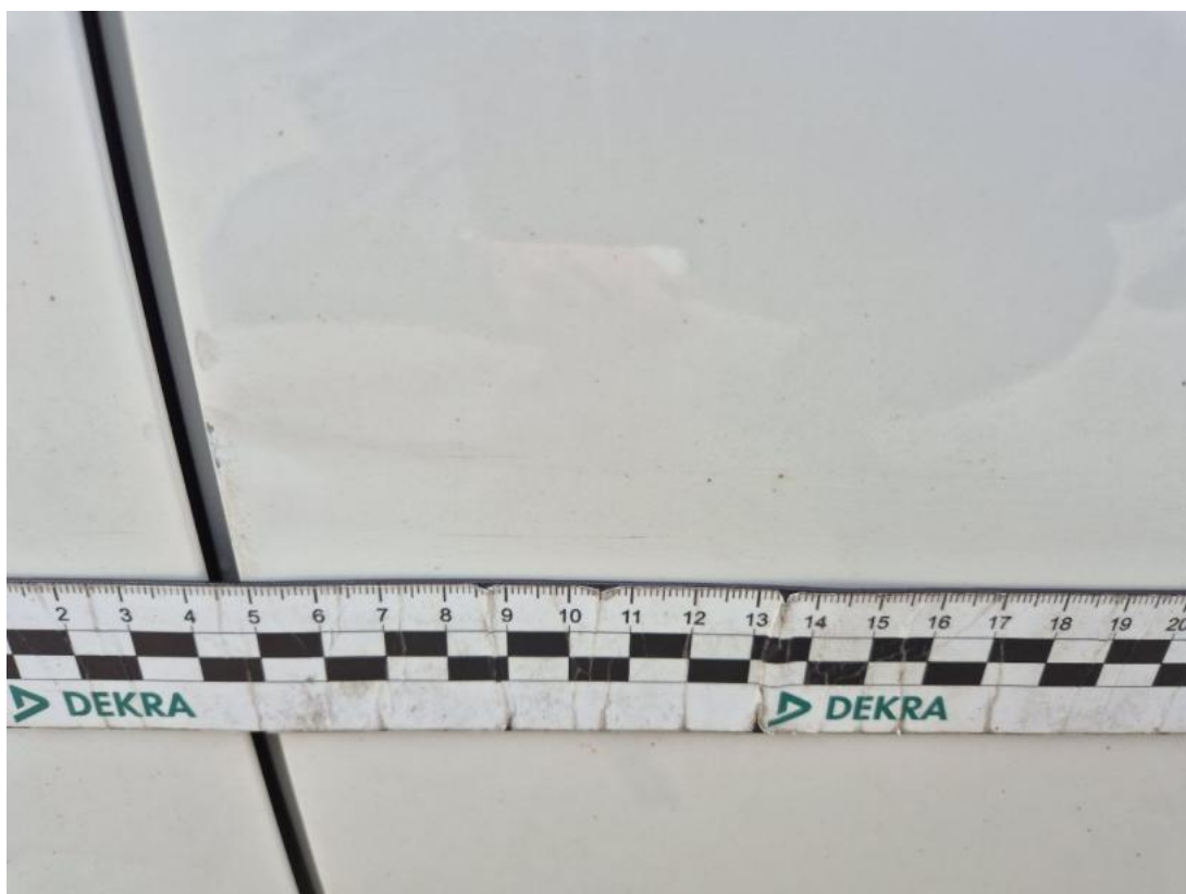
Fot. 59 Drzwi tylne L - Rysa/odprysk 1
