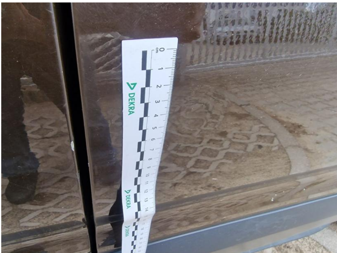
Fot. 38 Drzwi przednie P - Wgniecenie/odkształcenie 1
