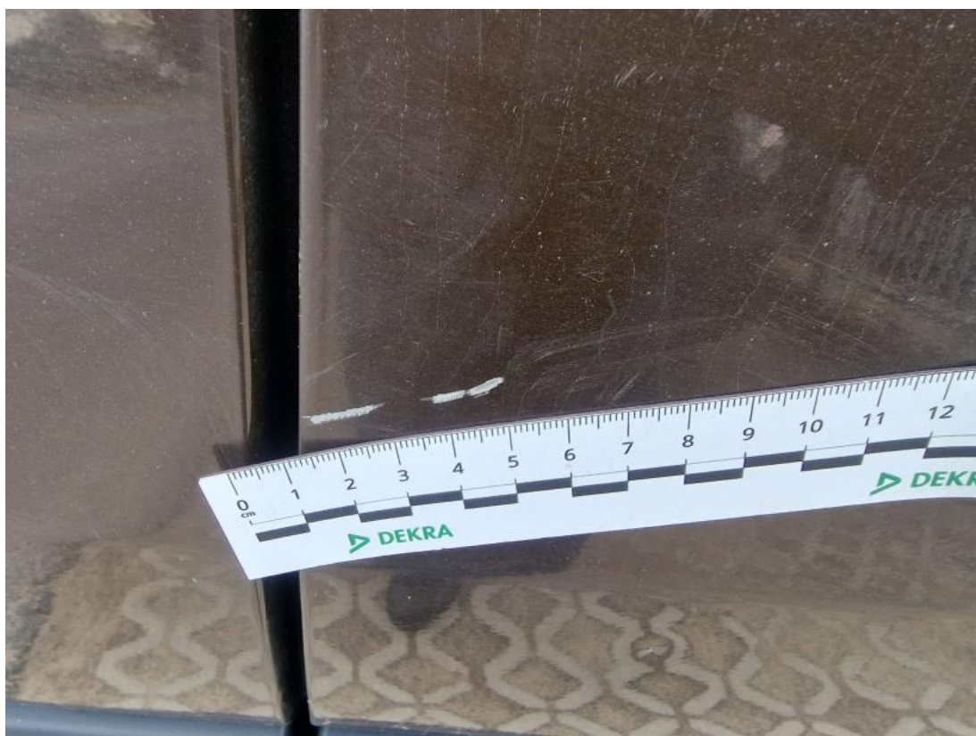
Fot. 45 Pokrywy bagażnika - Wgniecenie/odkształcenie 1
