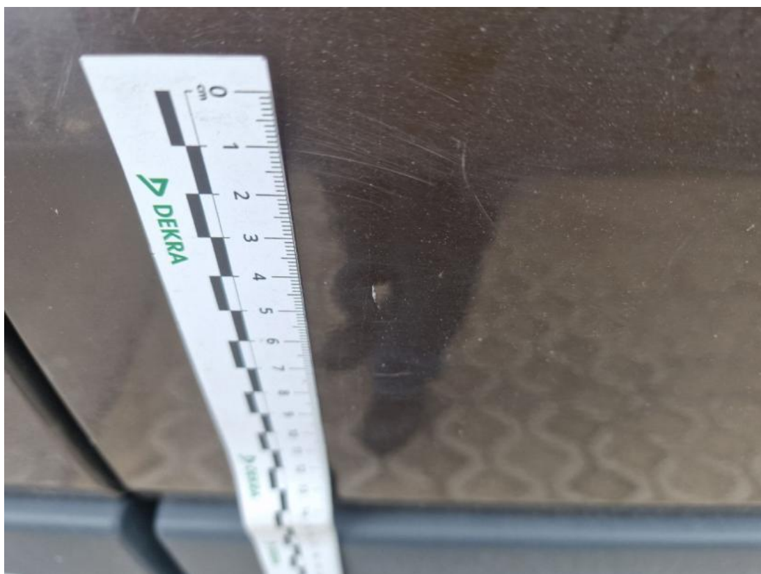
Fot. 46 Pokrywy bagażnika() - Wgniecenie/odkształcenie 3
